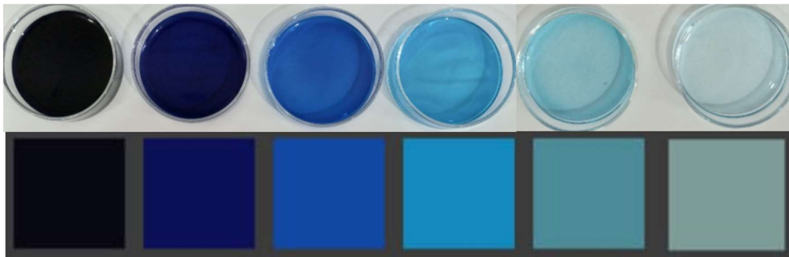
Figura 7 - Padrão de cores obtido pelo aplicativo Color Grab® para soluções de concentrações desconhecidas do azul de metileno
