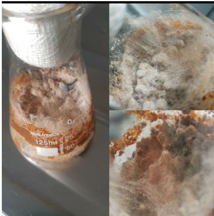
Figura 3 - Fotografia do frasco Erlenmeyer contendo o BM fermentado por Neurospora sp. em 72h de fermentação à 30 °C
