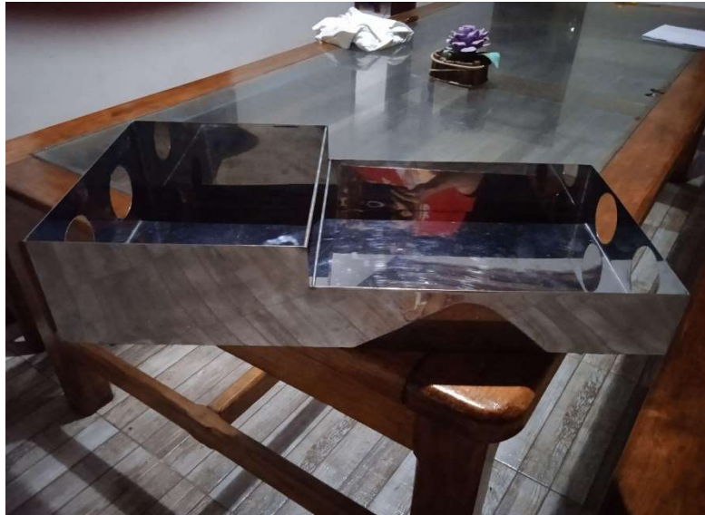
Figura 2 - Estrutura de aço depois de dobrada e soldada com barras de ferro paralelas como suporte
