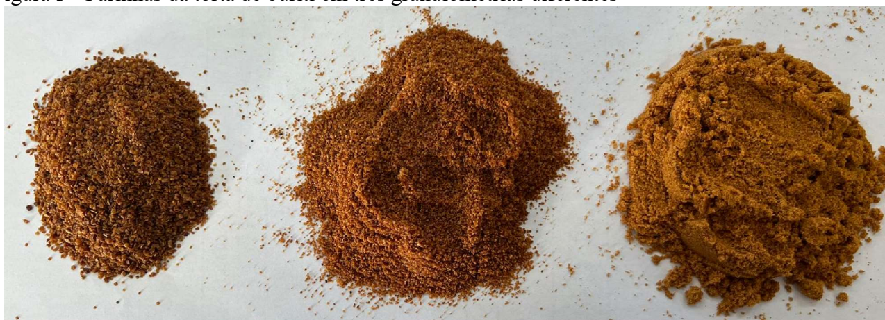
Figura 3 - Farinhas da torta de buriti em três granulometrias diferentes
