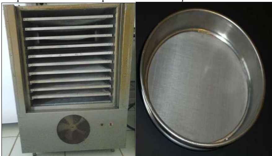
Figura 1 - Secador e peneira utilizados no processo de elaboração da farinha de beterraba
