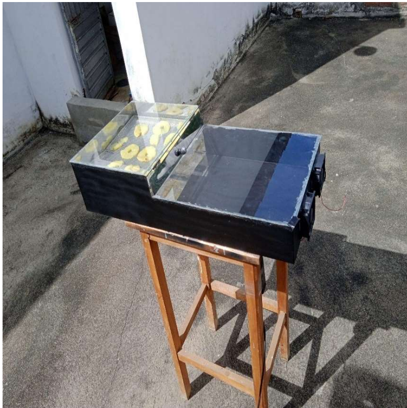
Figura 4 - Desidratador finalizado e em uso
