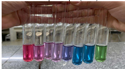
Figura 3 - Coloração do extrato em uma variação de pH (3-10)
