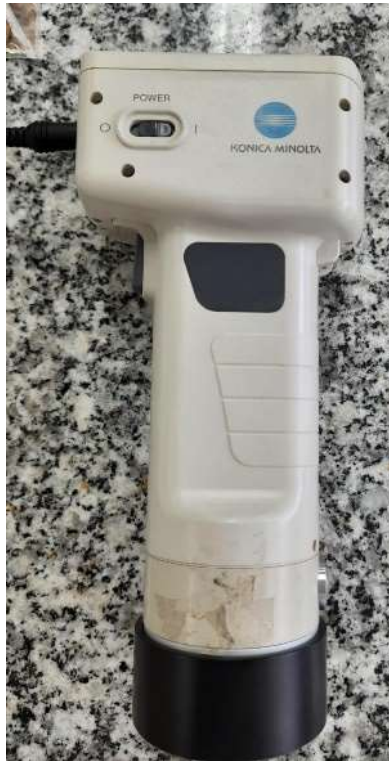
Figura 3 - Colorímetro Konica Minolta (Chroma Meter CR- 400)
