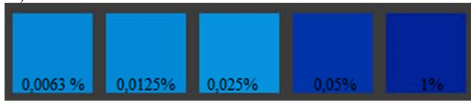
Figura 4 - Tonalidades de azul obtidas pelo aplicativo Color Grab® para diferentes concentrações do azul de metileno (v/v)
