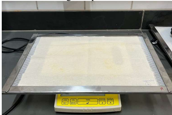
Figura 2- Bandeja preparada com tecido de algodão para receber a amostra da secagem
