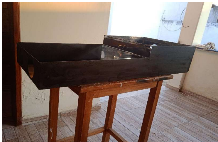
Figura 3 - Estrutura de aço com porta depois da pintura
