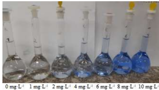
Figura 2 - Soluções com diferentes concentrações de Cu (II).
