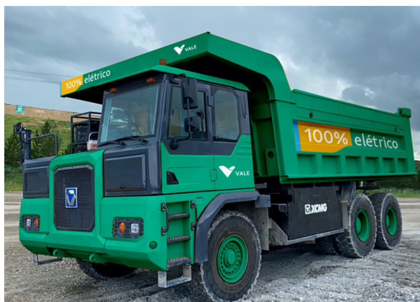
Figura 3: Caminhão elétrico de 72 toneladas da fabricante chinesa XCMG em teste no Brasil.
