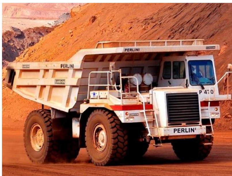
Figura 1: exemplo de caminhão do fabricante Randon Perlini (RDP 470, de 65 t)
