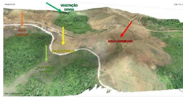
Figura 14 - Identificação das regiões conforme variação de tonalidades dos solos no Modelo 3D. Fonte: Autores.
