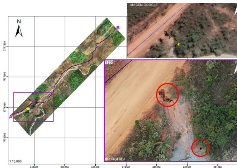
Figura 17 - Detalhe dos processos erosivos identificados durante análise do ortomosaico.
