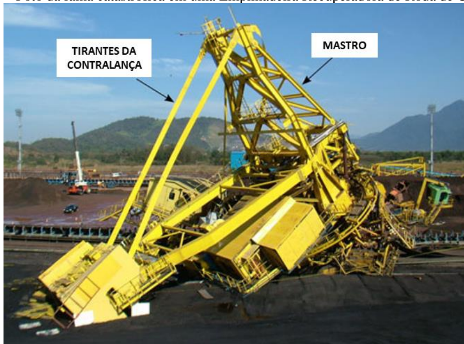
Figura 5 – Foto da falha catastrófica em uma Empilhadeira Recuperadora de Roda de Caçambas.
