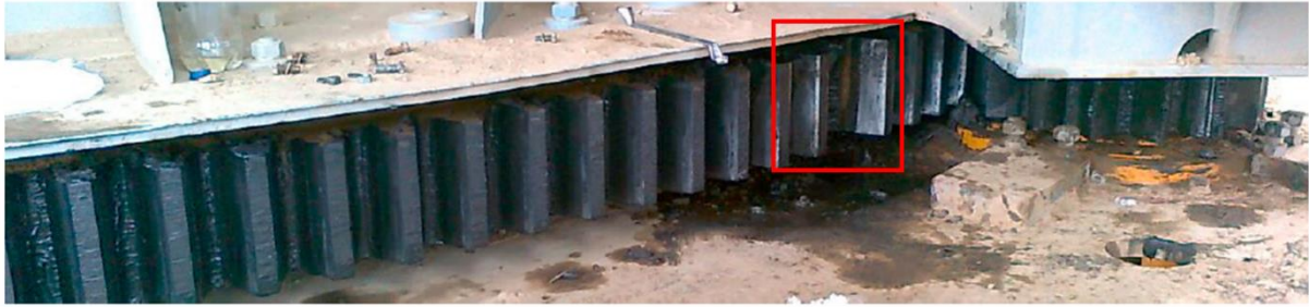
Figura 15 – Local de quebra do dente da engrenagem de giro.
