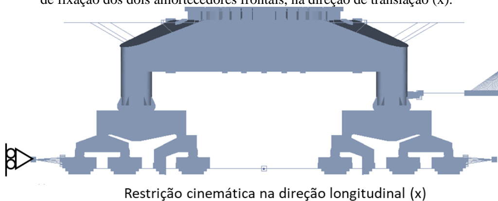
Figura 90 – Imagem do modelo computacional com aplicação das restrições cinemáticas nas regiões de fixação dos dois amortecedores frontais, na direção de translação (x).
