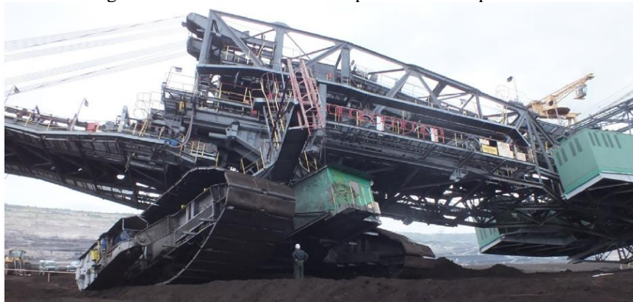
Figura 16 – Tombamento da empilhadeira recuperadora.
