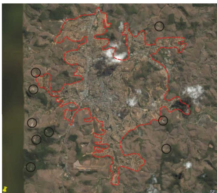
Figura 10 – Imagem Google Earth Pro, de agosto de 2002, da zona urbana e periurbana de Teófilo Otoni (MG), cujo limite está apresentado em vermelho. As áreas de ocorrência dos escorregamentos estão delimitadas pelos círculos pretos.
