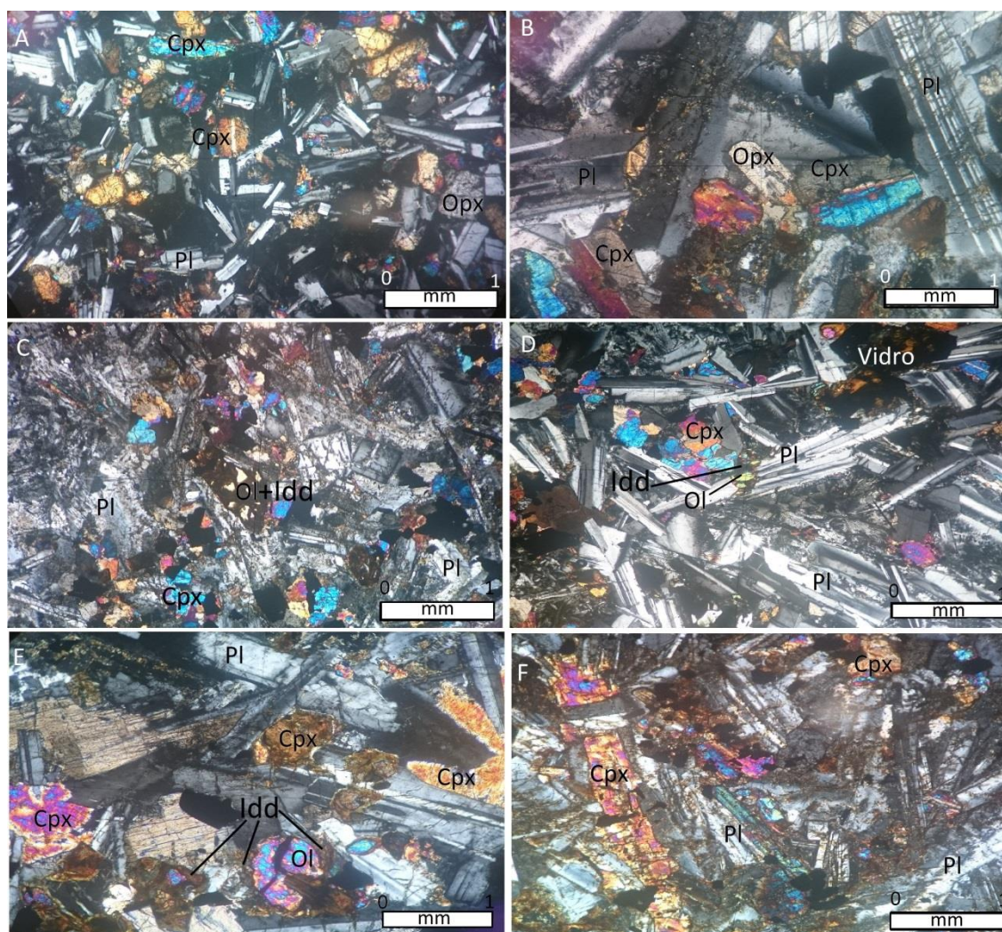
Figura 3. Fotomicrografias das amostras estudadas a polarizador cruzado, A: Amostra 1; B: Amostra 2; C: Amostra 3; D: Amostra 10; E: Amostra 14 e F: Amostra 8. Ol = Olivina, Pl = Plagioclásio, Cpx = Clinopiroxênio, Opx = Ortopiroxênio, Idd = iddingsita.
