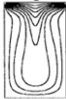
Figura 20 - Isotermas no interior de uma cavidade retangular aquecida nas laterais e resfriada na parte superior, para uma relação entre largura e altura (A) de 0,66 e 2.
