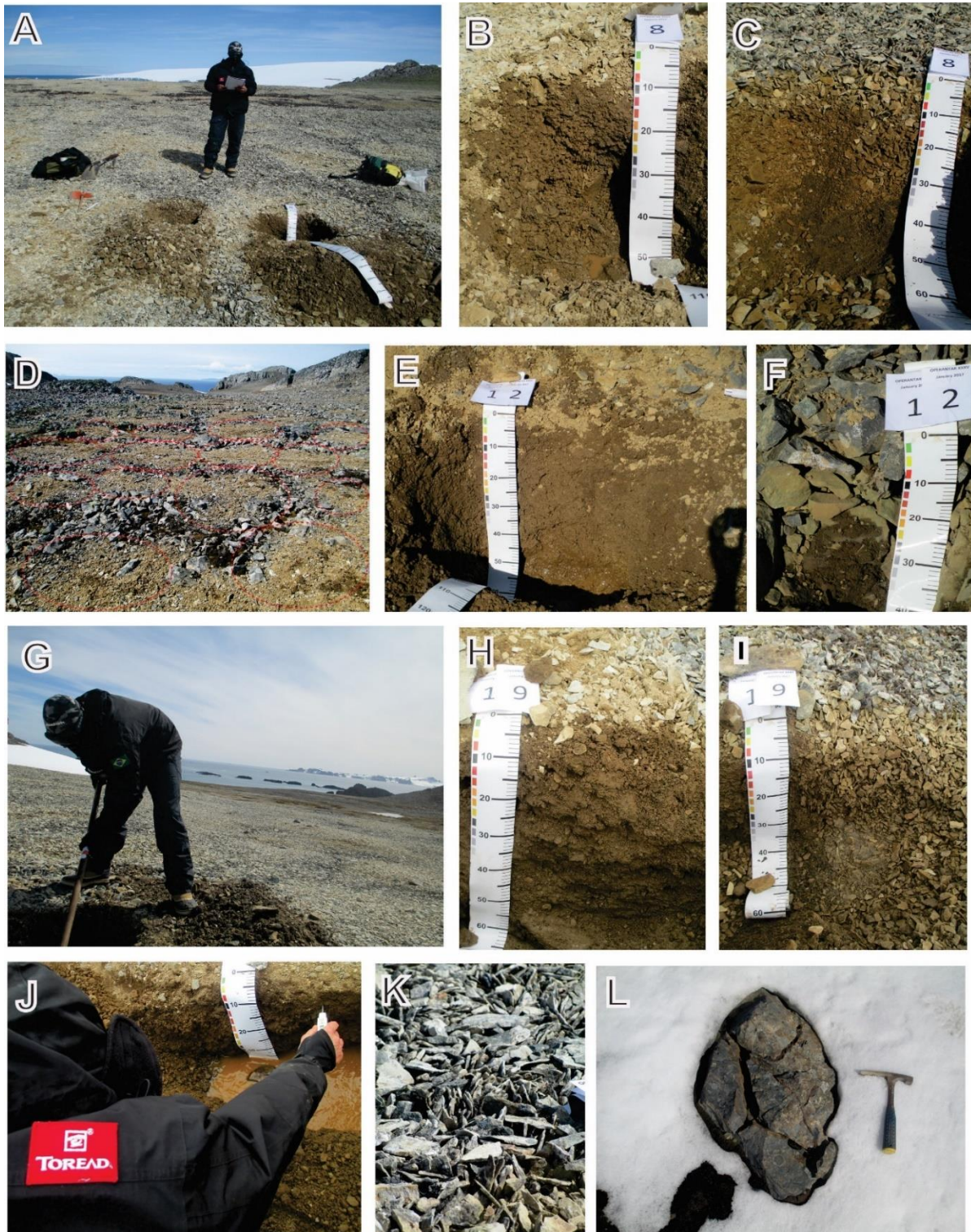
Figura 2. Representações das áreas com ocorrência de patterned ground na área de estudo. A – Paisagem com patterned ground e coleta no centro e na borda das superfícies padronizadas (P8); B – área central (P8); C – borda pedregosa (P8), com iluviação de matéria orgânica; D – paisagem de coleta do perfil 12; E – área central (P12), com brilho mais intenso do permafrost na base; F – borda pedregosa (P12); G – área de coleta do perfil 19; H – centro do perfil P19; I – borda do P19, com cimentação por gelo; J – medição da temperatura, com água do derretimento do permafrost minando na base; K - frost sorting ; L – intemperismo criogênico. Fonte: Arquivo dos autores.
