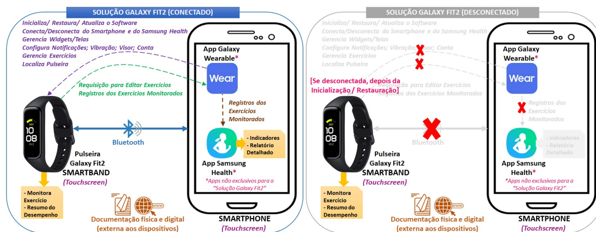
Figura 7.12: Visão geral da solução Samsung Galaxy Fit2 para promover a HInt, considerando todos os seus componentes em conjunto.
