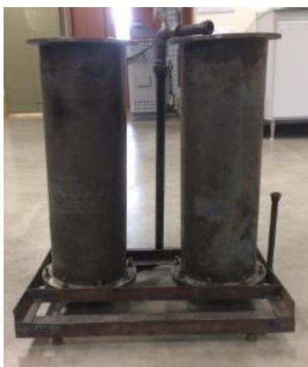
*Figura 3.1- Reator interligado utilizado no processo da cobertura da sílica ativa.*
