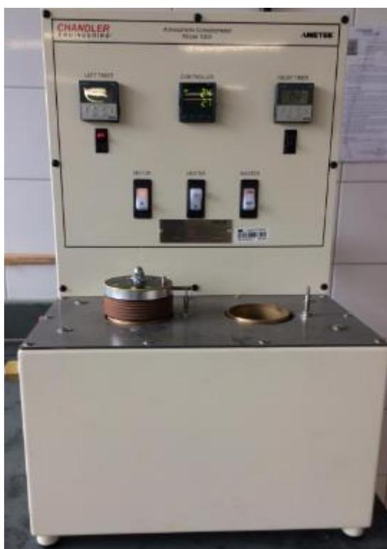
*Figura 3.6 - Consistômetro atmosférico.*
