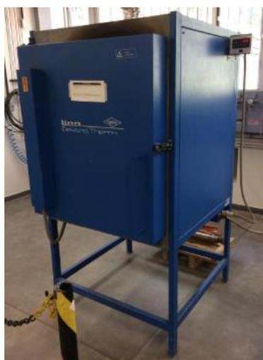
*Figura 3.2 – Mufla da marca Elektro Therm utilizada no processo de pirólise.*
