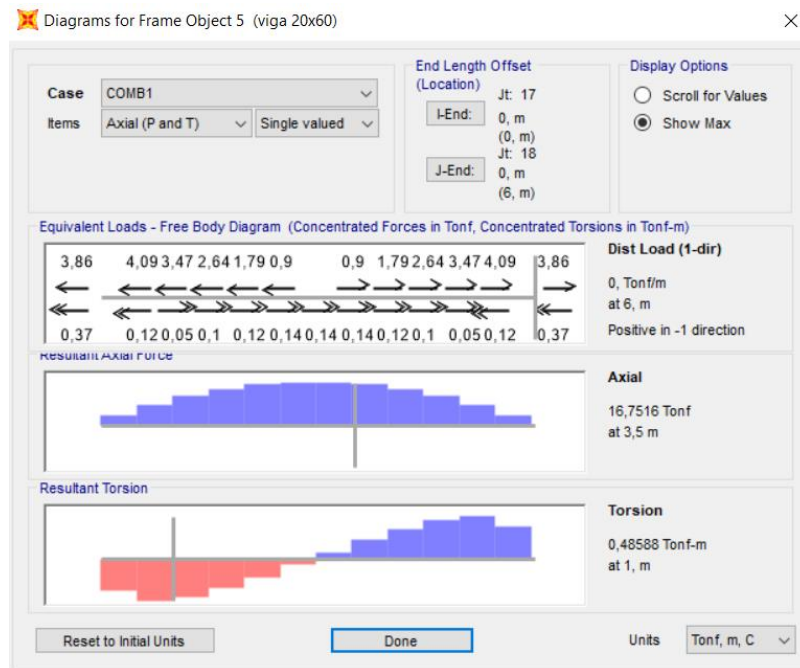
Figura 48. Esforços solicitantes axiais e torcionais nas vigas da laje do modelo tipo 2 do SAP2000.
