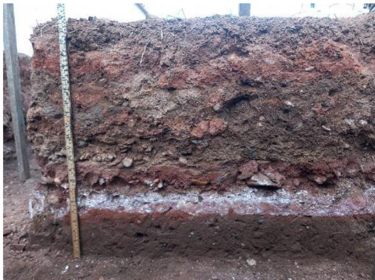
Figura 79 - estratigrafia do trecho 1, trincheira 3.
