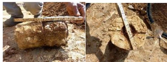
Figura 98 - Manilha com 27cm de comprimento e 15cm de diâmetro.
