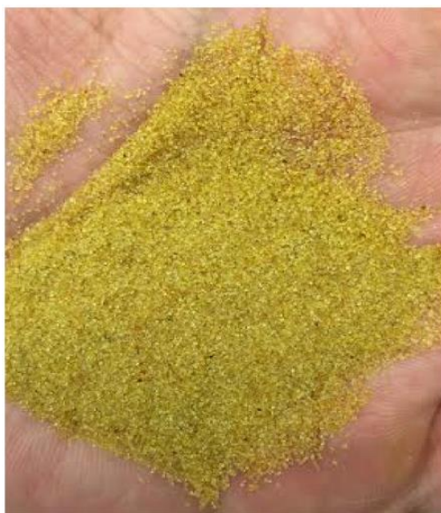
Figura 3.2 - Curable Resin-Coated Sand antes do bombeamento para o poço. Fonte: Belyadi (2017)
