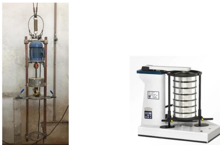
Figura 4.4 - Peneirador suspenso. Laboratório de processamento mineral – UFMG e Ro-Tap RX-29. Medicaexpo, 2022.
