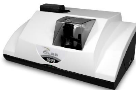
Figura 4.6 - Granulômetro a laser CILAS 1190. Acilweber, 2022: https://www.acilweber.com.br/
