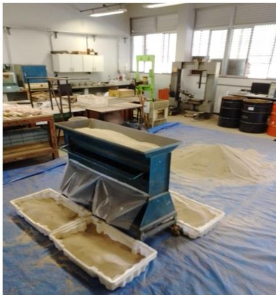
Figura 4.2 - Homogeneização por pilha cônica e amostragem em divisor de rifles.
