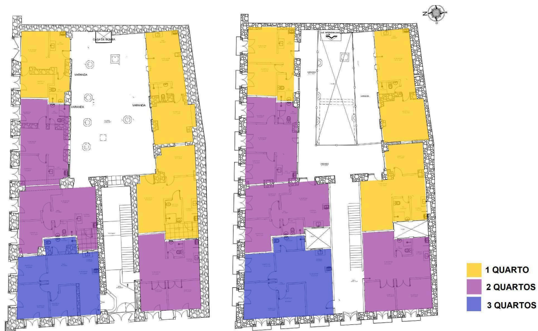
Figura 39 - Planta do primeiro e segundo pavimento do sobrado na rua da Palma com indicação de apartamentos por categoria.
