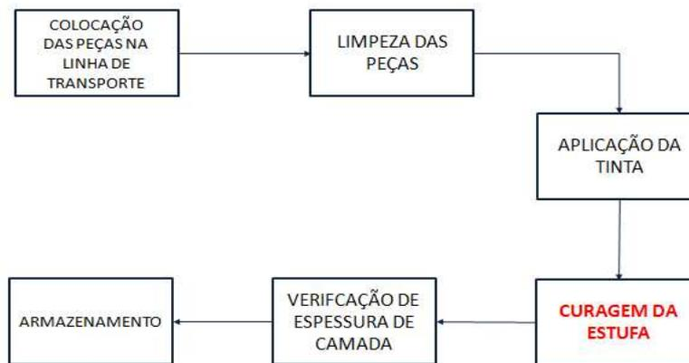
Figura 1 - Fluxograma do processo de pintura eletrostática
