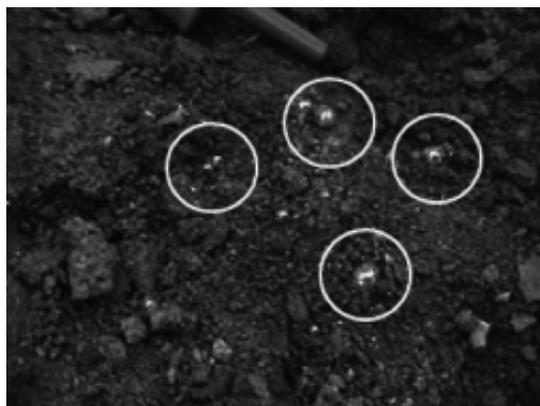
Figura 2. Detalhe do afloramento do mercúrio elementar no solo (Fonte: Tinôco et al., Avaliação de contaminação por mercúrio em Descoberto, MG, 2010).
