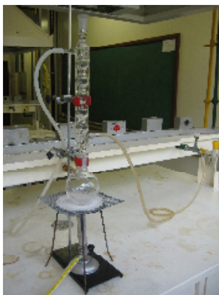
Figura 1.1: Ilustração da montagem utilizada na preparação da acetanilida.
