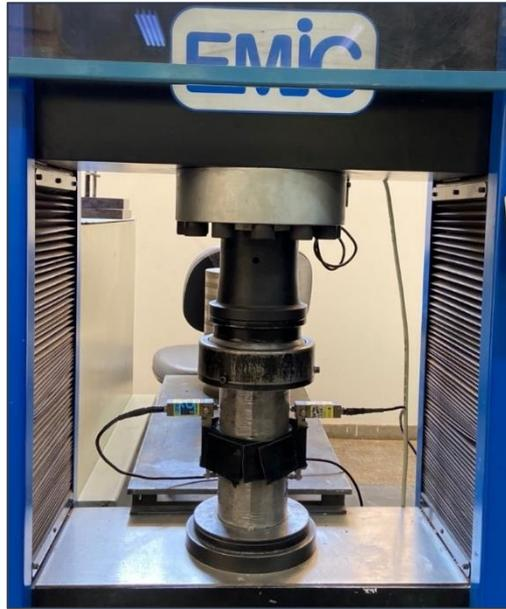
O módulo de elasticidade inicial  $E_{ci}$  de cada corpo de prova é calculado de acordo com a Equação 3.2:
