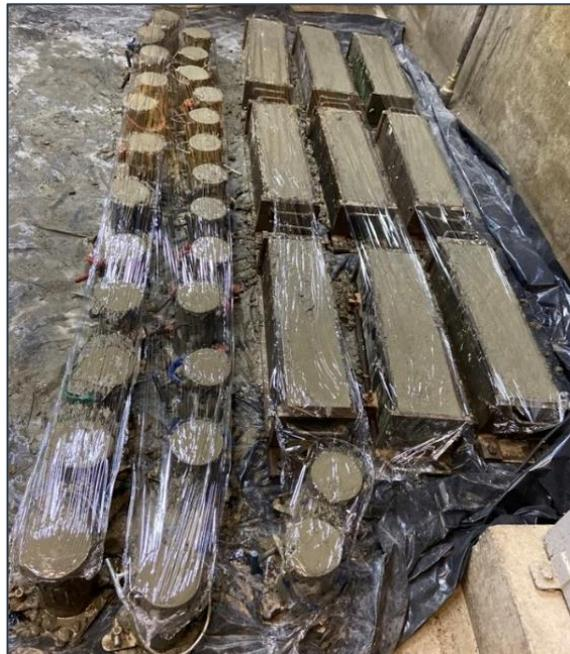
Após 24 horas os corpos de prova foram levados para a câmara úmida para a cura, onde a temperatura e a umidade eram mantidas em 23,5 °C e 97% respectivamente. Os corpos de prova permaneceram ali até a data de ensaio, quando foram retirados, identificados. Os corpos de prova cilíndricos foram retificados, como mostra a Figura 3.17, garantindo uma superfície lisa
