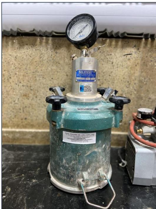
Primeiramente, o concreto foi colocado no recipiente e vibrado com o uso de vibrador de imersão. Após o adensamento, a superfície do concreto foi rasada com uma régua metálica. O equipamento foi fechado, assim como a válvula de ar principal e as chaves A e B foram abertas. Injetou-se água por uma das chaves até que a água saísse pela outra chave. Bateu-se no recipiente com um martelo de borracha até que todo o ar fosse expulso.
