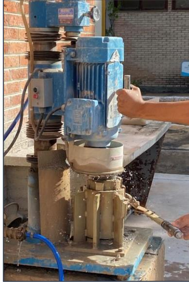
Figura 3.18 – Corpos de prova cilíndricos preparados para ensaios de propriedades mecânicas
