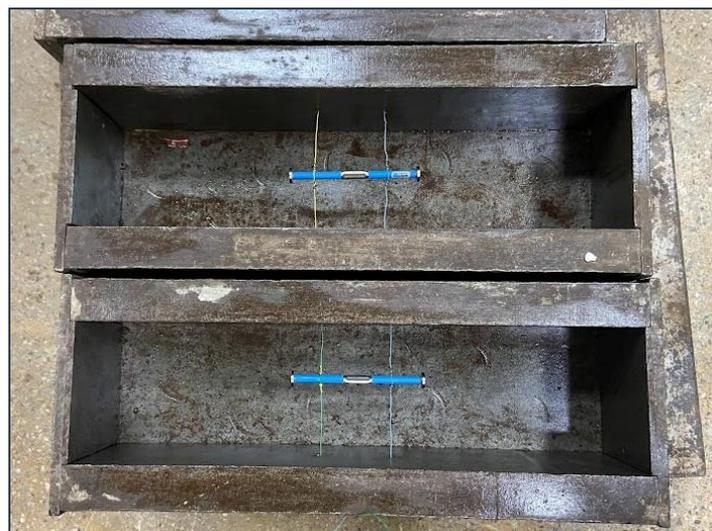
Antes da concretagem dos corpos de prova para o ensaio de fluência básica, foram embutidos extensômetros elétricos medidores de deformação, que foram posicionados no eixo dos moldes e na posição vertical, conforme mostra a Figura 3.15. Após moldados, os corpos de prova
