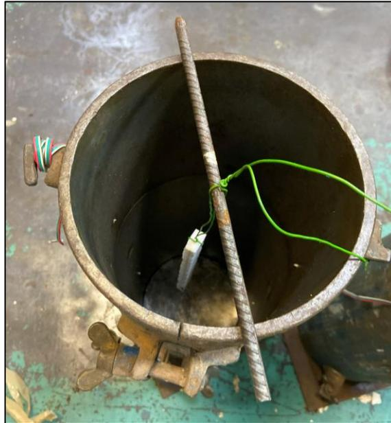
Figura 3.16 - Corpos de prova logo após a moldagem
