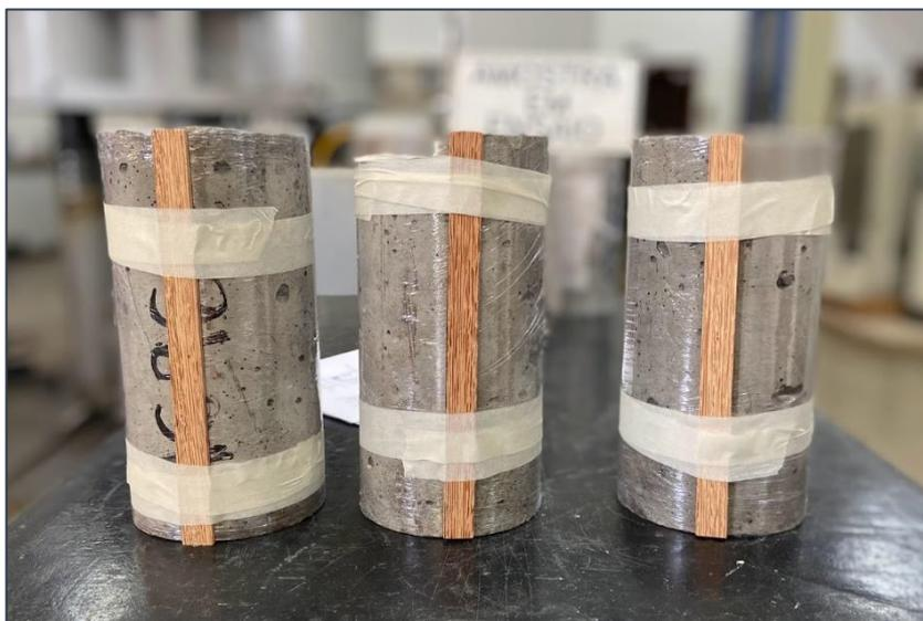
Após a determinação da altura e do diâmetro dos corpos-de-prova, foram traçadas duas linhas para traçar o plano axial e as tiras de madeira foram coladas nessas linhas. Os pratos foram posicionados e a carga foi aplicada continuamente com o crescimento constante a uma velocidade de  $(0,05 \pm 0,02)$  MPa/s até que os corpos-de-prova rompessem. A Figura 3.24 mostra a preparação do ensaio.
