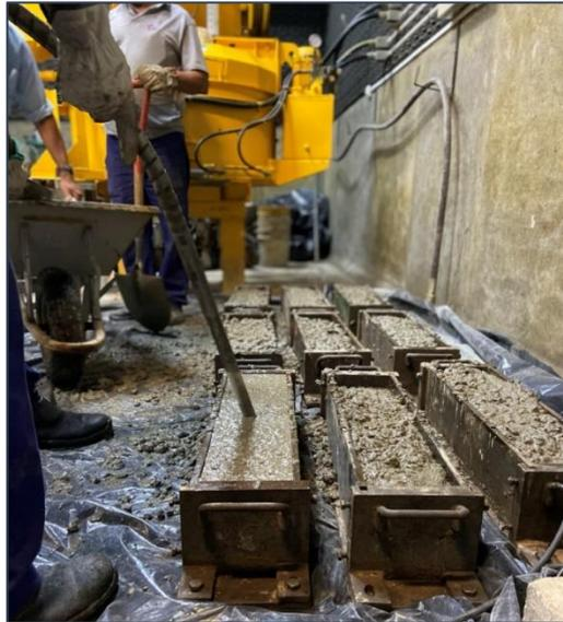
Antes da concretagem dos corpos de prova para o ensaio de retração autógena, foram posicionados extensômetros do tipo corda vibrante no concreto, de modo que seus eixos coincidisse com o eixo dos moldes, como mostra a Figura 3.14.
