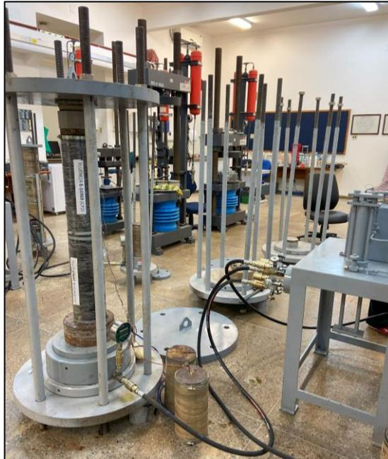
Após a realização do ensaio, o cálculo da deformação da fluência básica foi feito através da Equação 3.7 a seguir.
