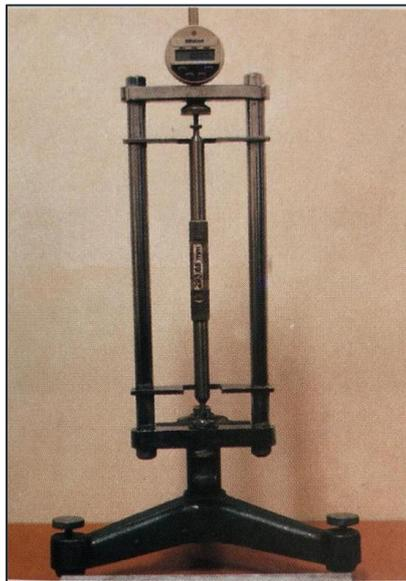
Figura 3.29 - Corpo de prova sendo medido no aparelho medidor
