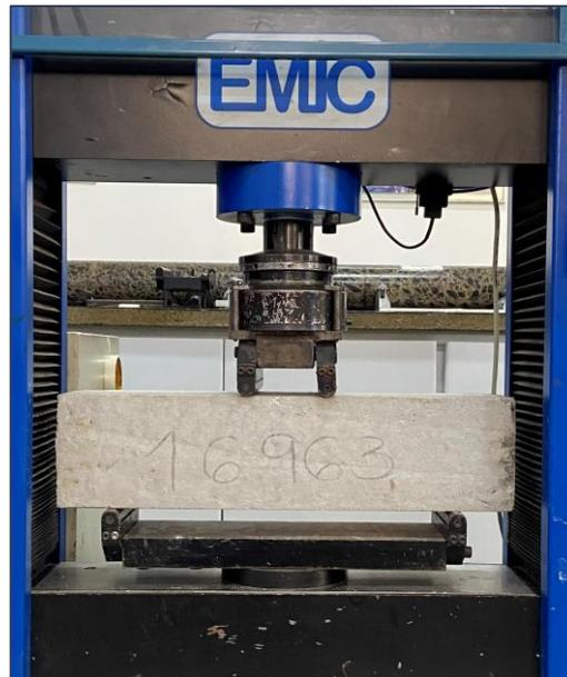
Após a realização do ensaio foi medido o corpo-de-prova em sua seção de ruptura e calculada a resistência à tração de acordo com a Equação 3.3:
