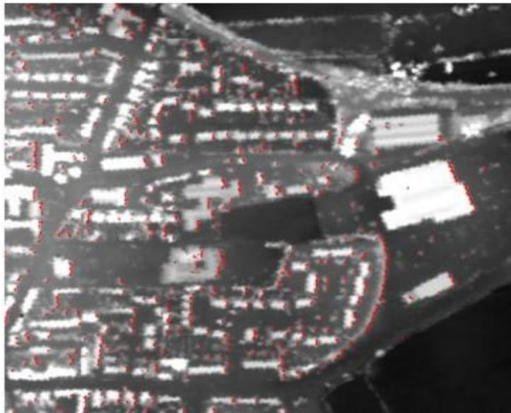
Figura 2. 14 - Regiões propensa a ocorrência do efeito *double bounce*, (em vermelho)
