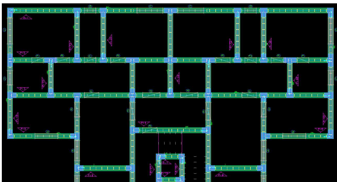
Figura 80: Delimitação das paredes no TQS Alvest
