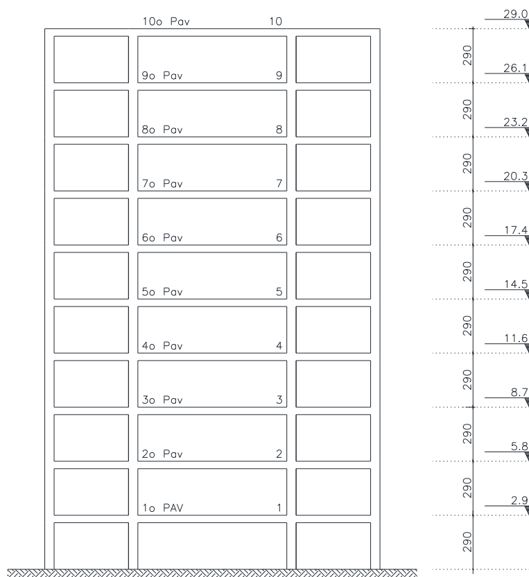
Figura 2: Corte esquemático da estrutura
