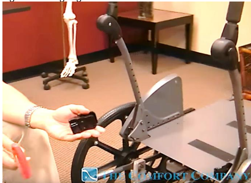
Figura 17 – Regulagens de altura na cadeira de rodas
