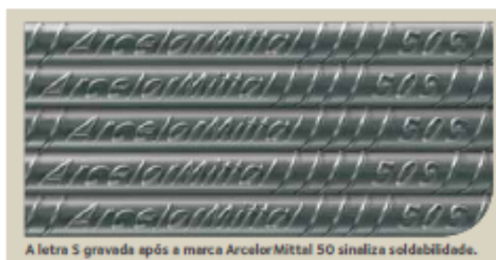
A letra S gravada após a marca ArcelorMittal 50 sinaliza soldabilidade.
