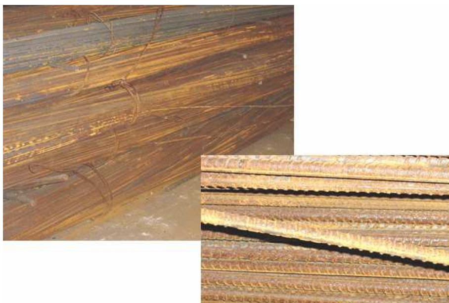
Figura 1 - Vergalhão aço carbono oxidado
