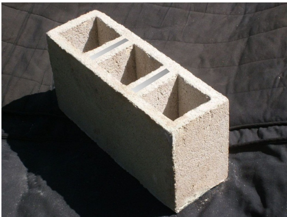
Figura 4- Vista superior do Bloco Somontar. Superfície plana que recebe a saliência do bloco caracterizando o seu encaixe e os vazios laterais para facilitar a separação dos módulos.
