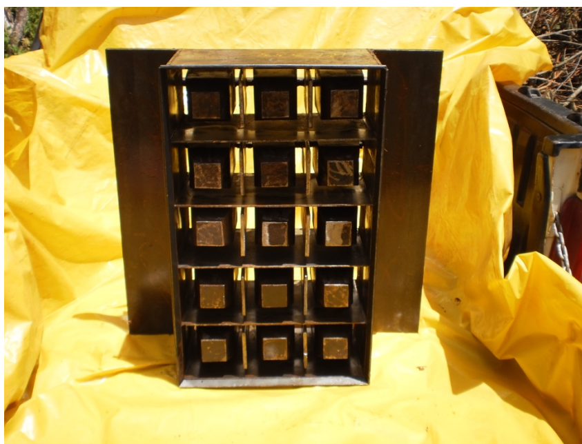
Figura 5– Forma metálica utilizada na fabricação dos Blocos Somontar.
