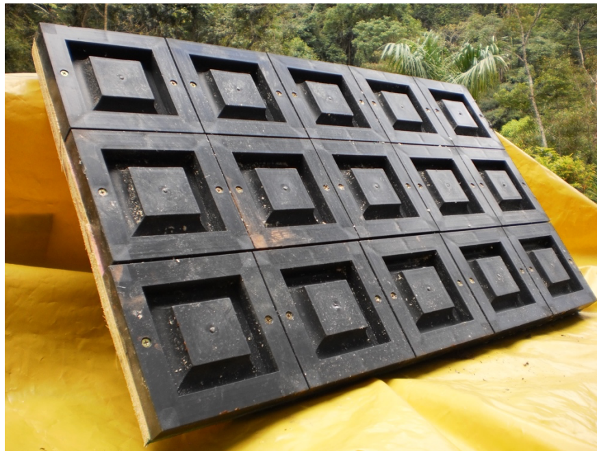
Figura 7 – Molde plástico utilizado na fabricação dos Blocos Somontar.
