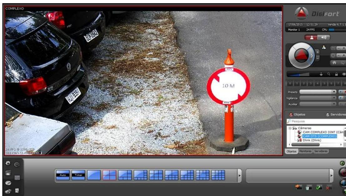
FIG 14 – Teste da funcionalidade zoom óptico com câmera, foco no cone a 10 metros
