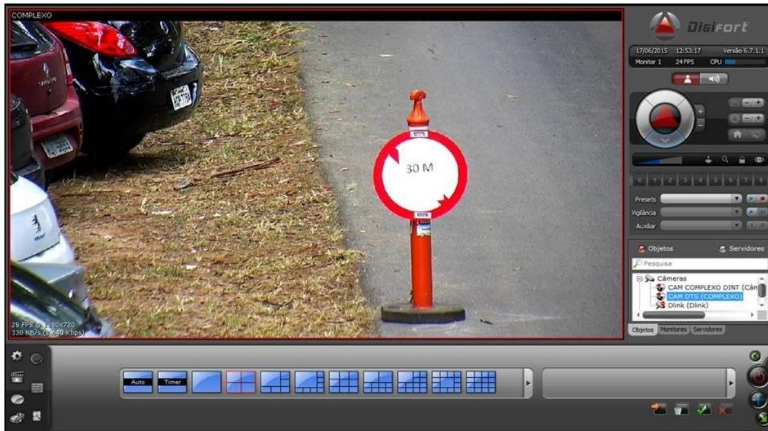
FIG 16 – Teste da funcionalidade zoom com câmera, foco no cone a 30 metros
