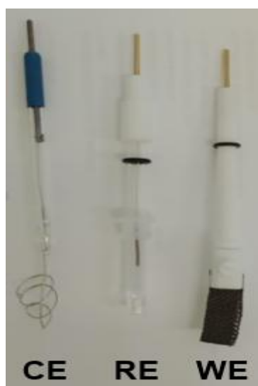
Figura 16. Eletrodos utilizados nas caracterizações eletroquímicas, sendo CE o contra eletrodo, RE o eletrodo de referência Ag|AgCl (KCl sat.) e WE o eletrodo de trabalho.
