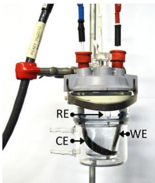
Figura 15. Adaptação de esquema ilustrativo de célula eletroquímica em meio aquoso, onde estão indicados o eletrodo de trabalho - constituído pelo material ativo (WE), o de referência Ag|AgCl (KCl sat.) e o contra eletrodo, um fio de platina (CE).
