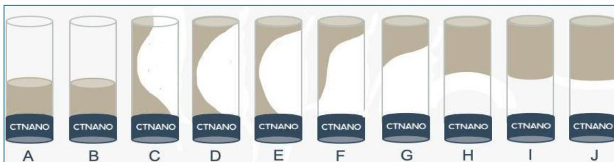
**Figura 13.** Representação do teste de tubo invertido para análise dos códigos de força-gel de Sydansk (SYDANSK, 1990).
