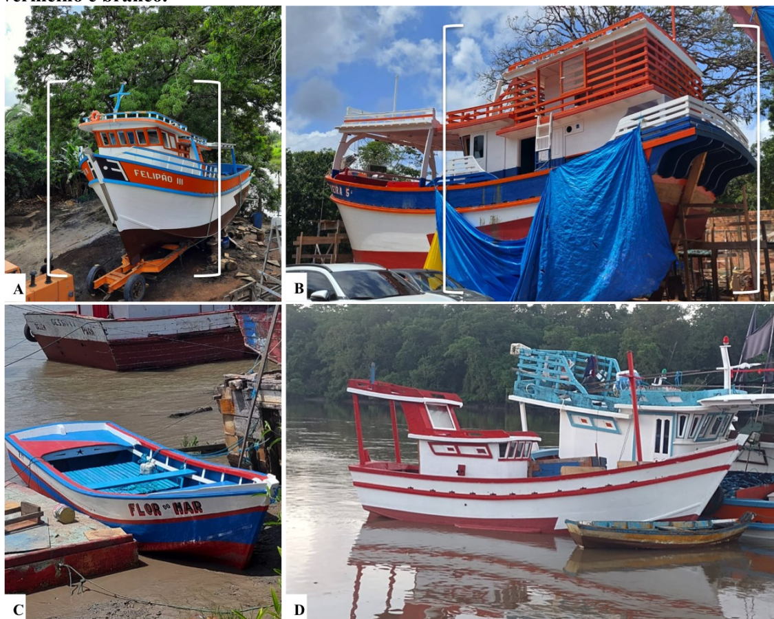
Figura 57. Na imagem A. barco, com o comando sobre a dianteira da embarcação; na B. lancha, com o comando sobre a parte traseira da embarcação C. canoa e D. bote em vermelho e branco.
