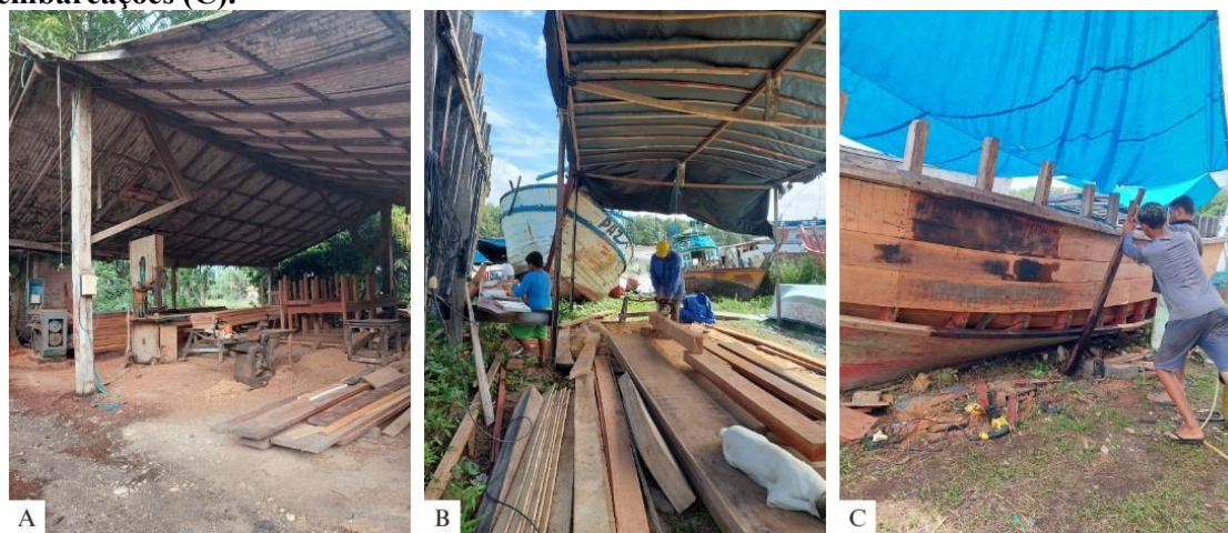
Figura 45. Galpão coberto de telha de fibrocimento (A), de lona (B) e lonas sobre as embarcações (C).
