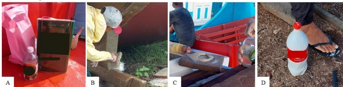
Figura 55. A. Catalisador e resina, B. camadas de fibra, C. mistura de resina com talco industrial, D. thinner com cera de vela.
