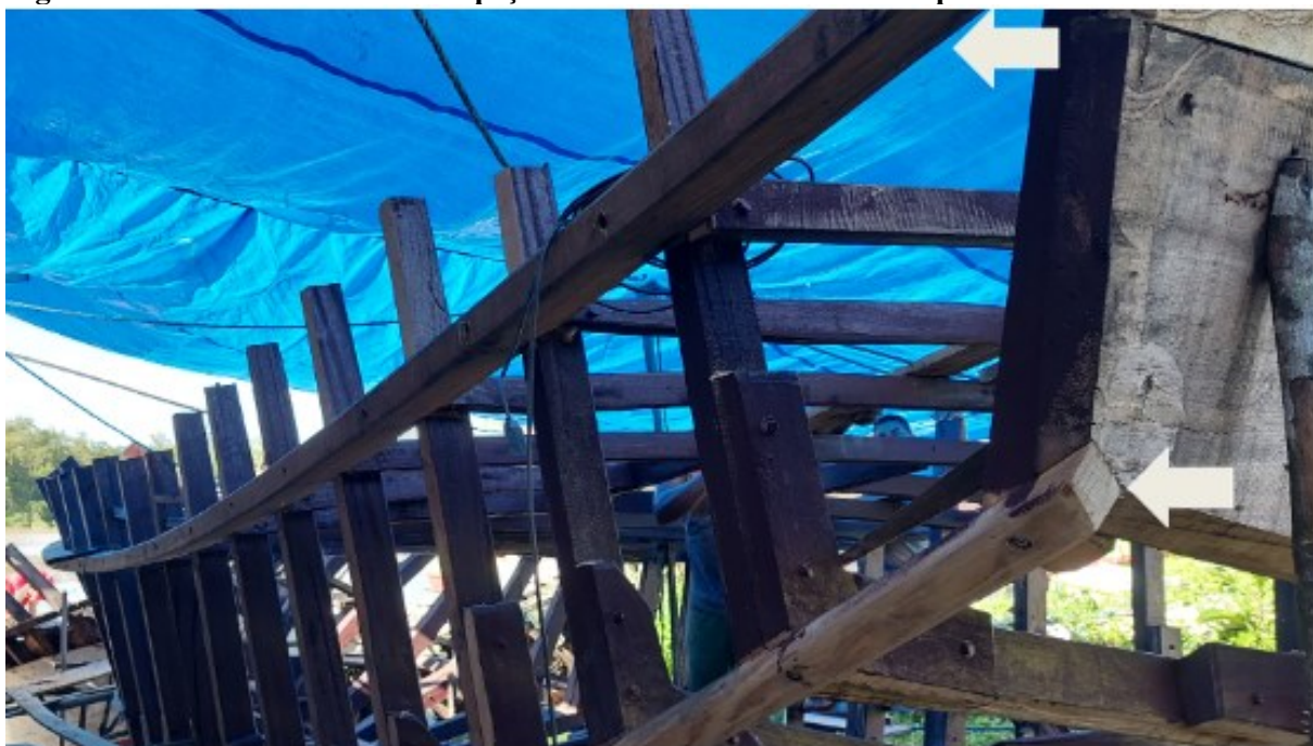
Figura 77. A seta inferior indica a peça chamada de canto e a seta superior o cintado .
