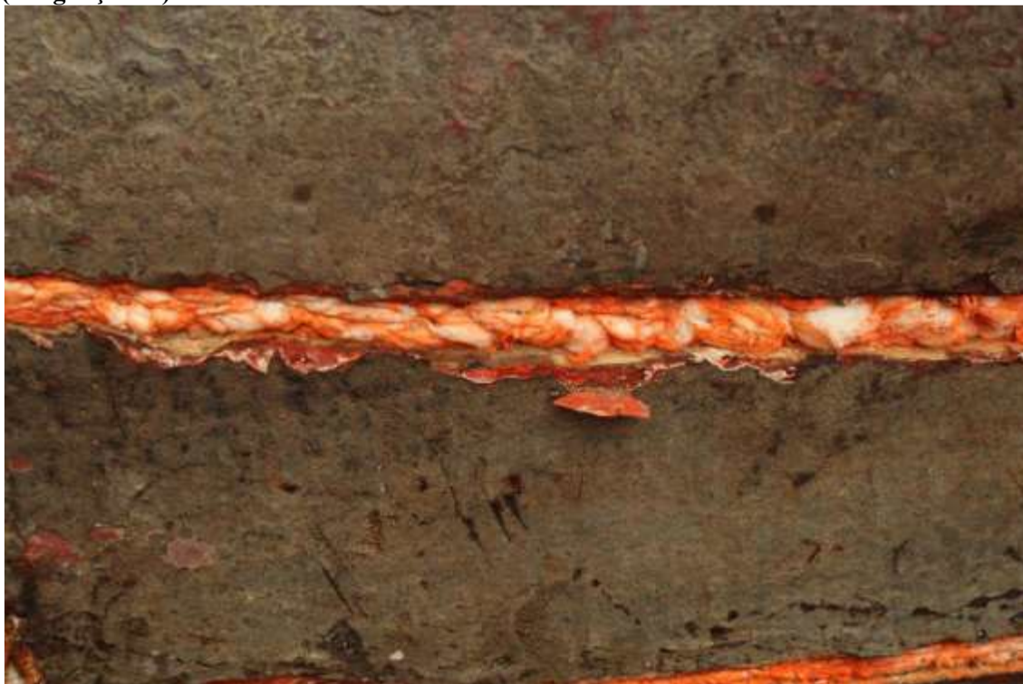
Figura 52. Algodão tingido com zarcão colocado nas “costuras” da embarcação (Bragança/PA).
