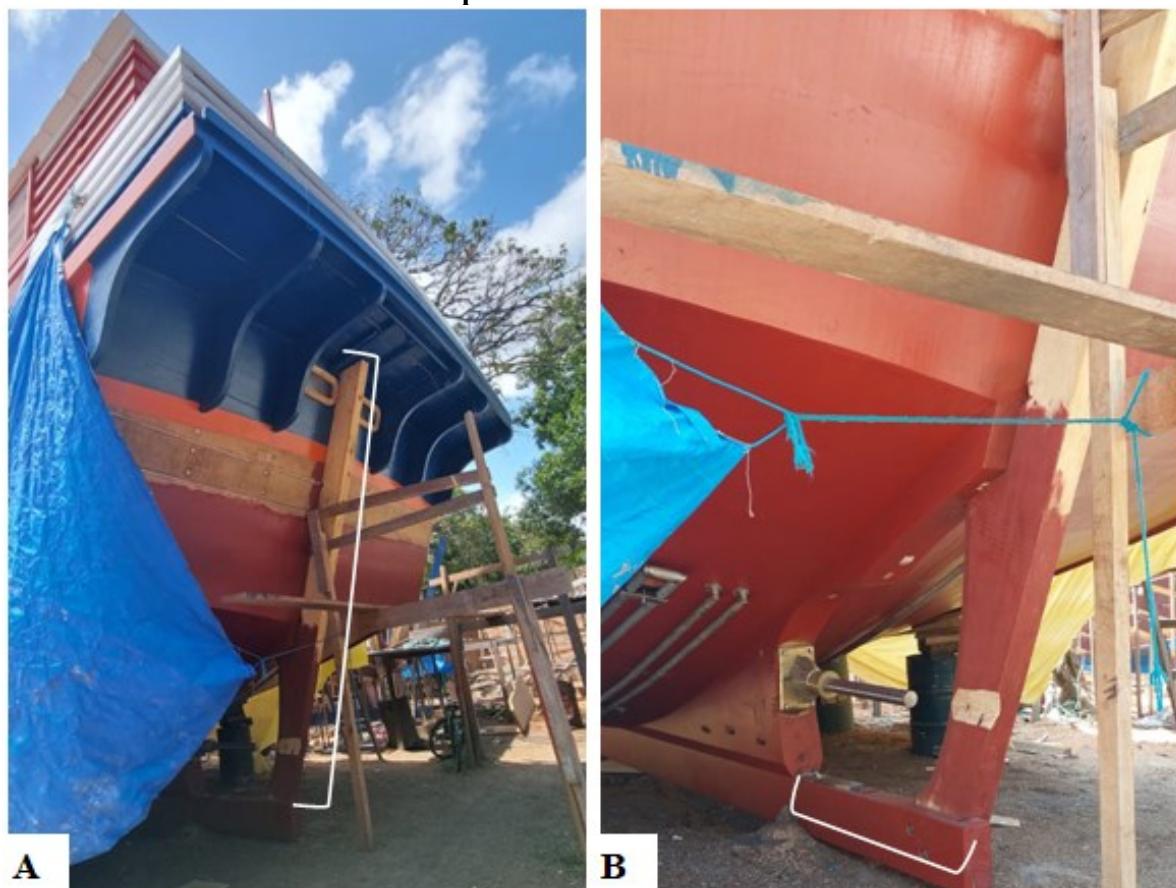
Figura 63. Na imagem A. destaca-se o cadaste, peça em que o leme é fixado, na B. destaca-se a distância da bucha até o fim da quilha.
