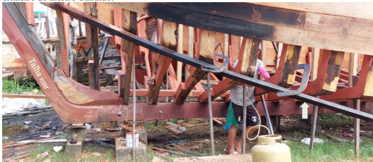
Figura 78. Ajudante modelando o canto do barco por aquecimento com maçarico no estaleiro do mestre Cândido.
