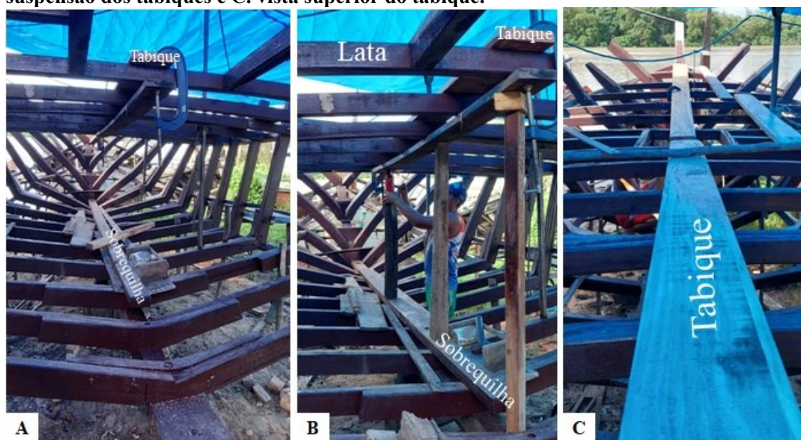
Figura 79. Na imagem A. disposição das peças do tabique e da sobrequilha, B. etapa de suspensão dos tabiques e C. vista superior do tabique.
