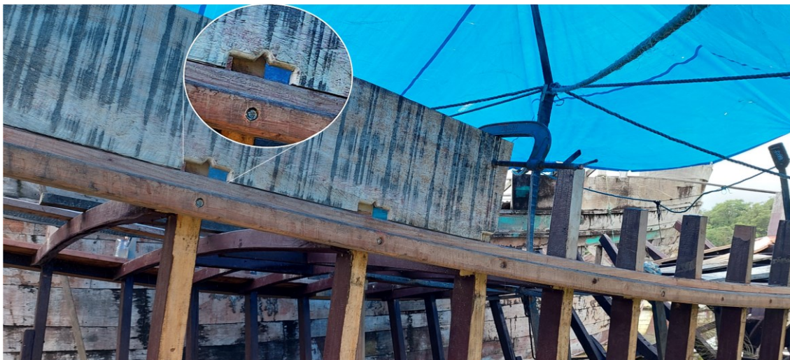
Figura 81. Entabuamento da borda do convés e suas bueiras indicada pela ampliação da área.
