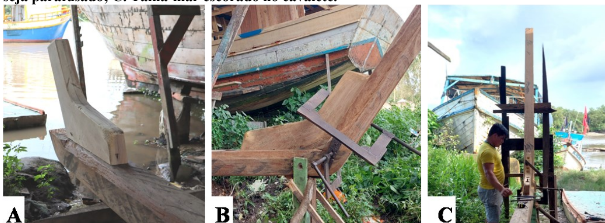
Figura 69. A. coral da proa; B. gancho prendendo o coral da proa ao talha-mar até que seja parafusado; C. Talha-mar escorado no cavalete.
