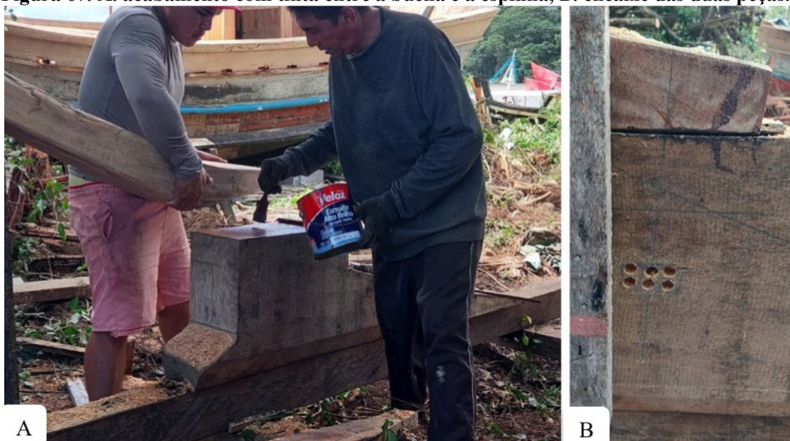
Figura 67. A. acabamento com tinta entre a bucha e a espinha, B. encaixe das duas peças.
