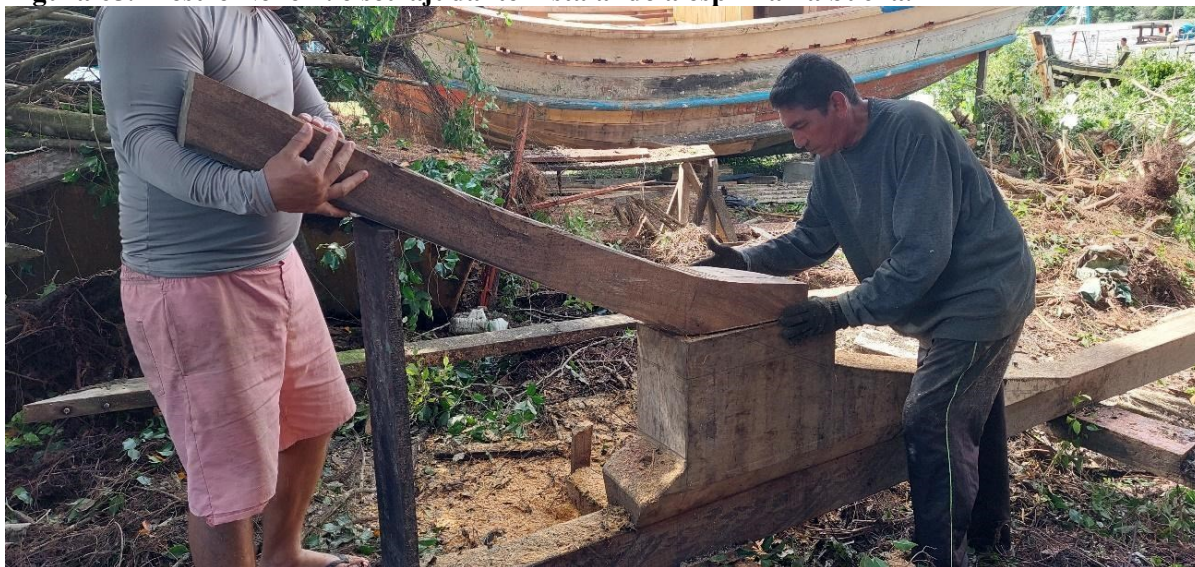
Figura 65. Mestre Neném. e seu ajudante instalando a espinha na bucha.
