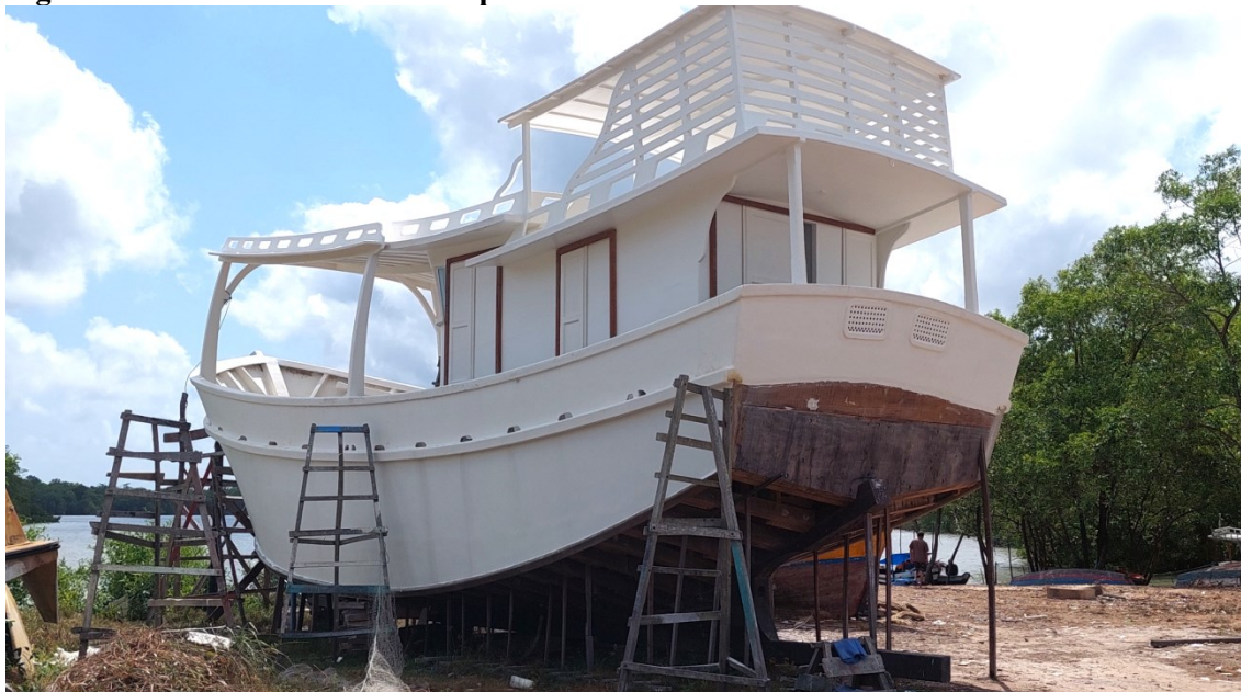
Figura 84. Lancha com o casco de plástico-alumínio revestido de fibra.
