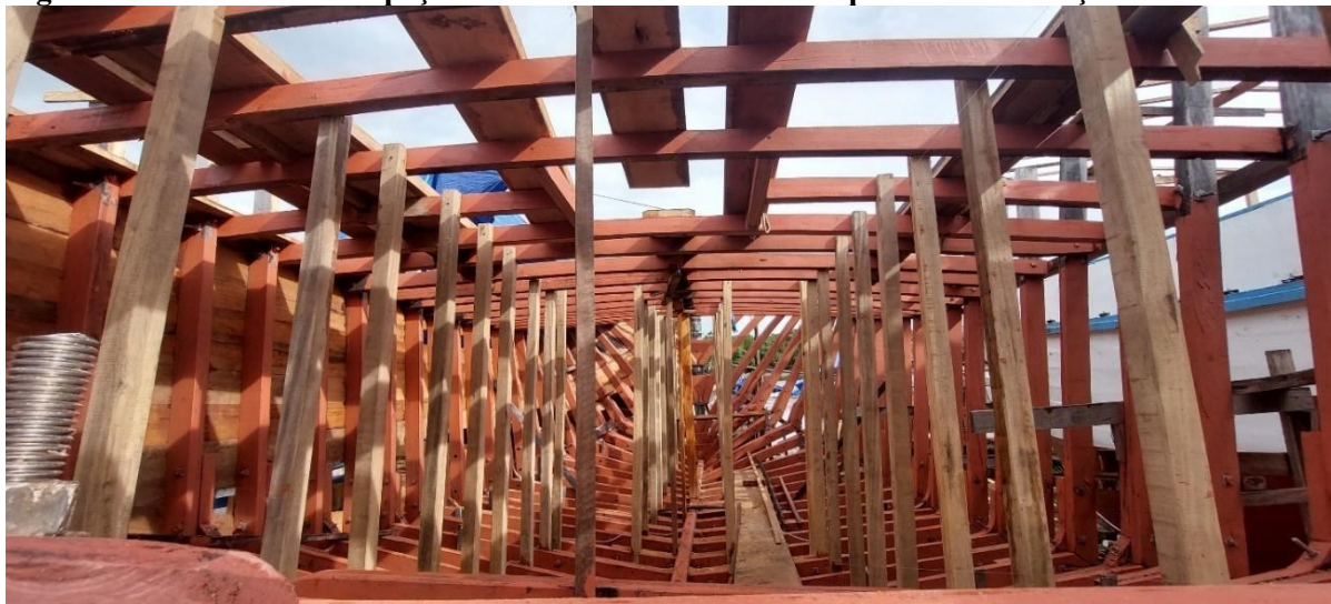
Figura 85. Os barrotes são peças estruturais das urnas e tanques da embarcação.
