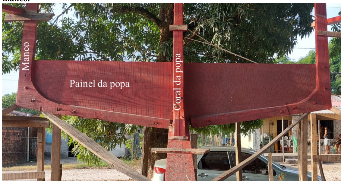
Figura 68. Visão frontal da popa da embarcação, indicando o coral da popa, o painel e o manco.
