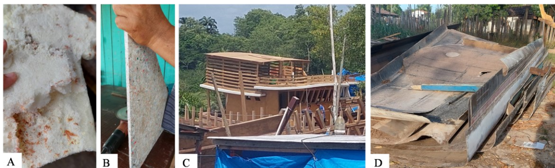
Figura 90. A. espuma de poliuretano, B. placa de plástico-alumínio, C. compensado naval e D. teto de ônibus.
