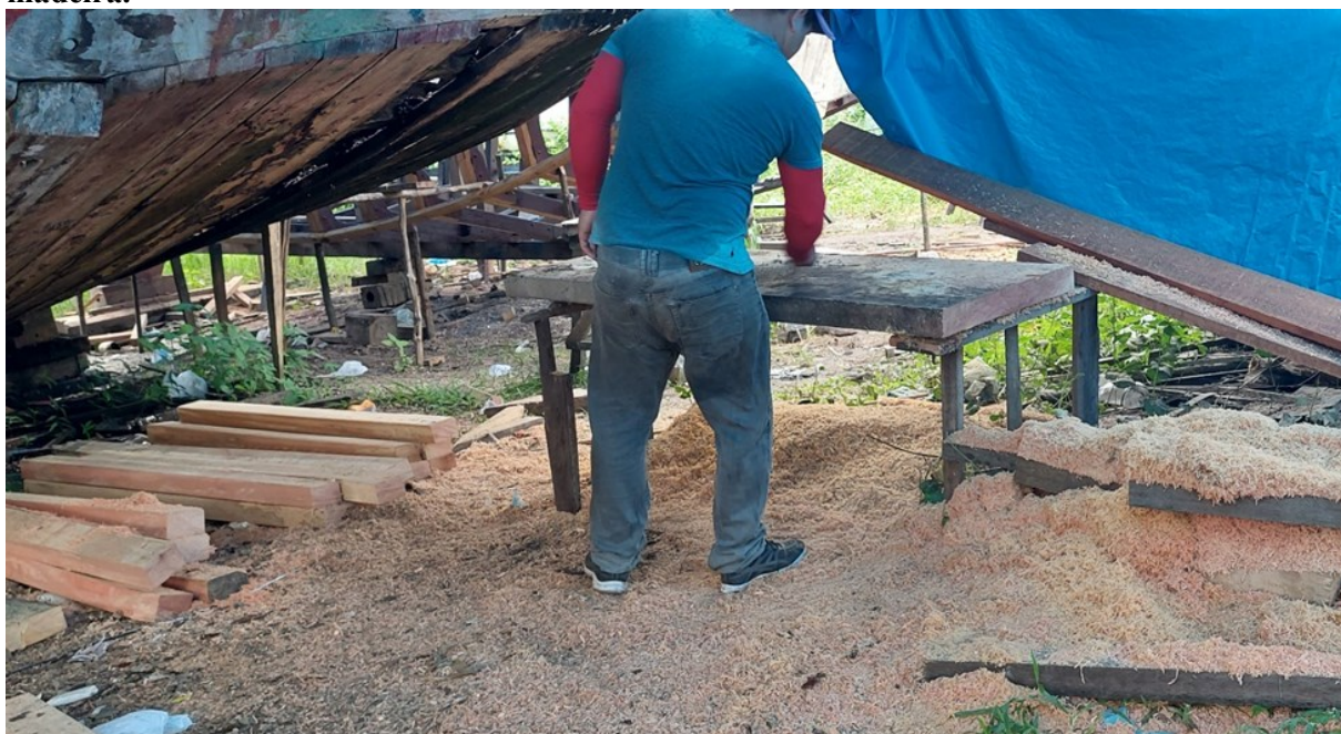
Figura 74. Confeção das peças que compõem as cavernas a partir do pranchão de madeira.
