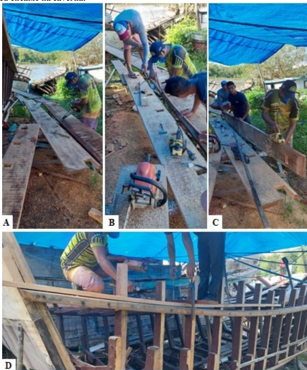
Figura 80. A sequência de imagens mostra a confecção das tábuas das margens do convés e o seu encaixe na caverna.
