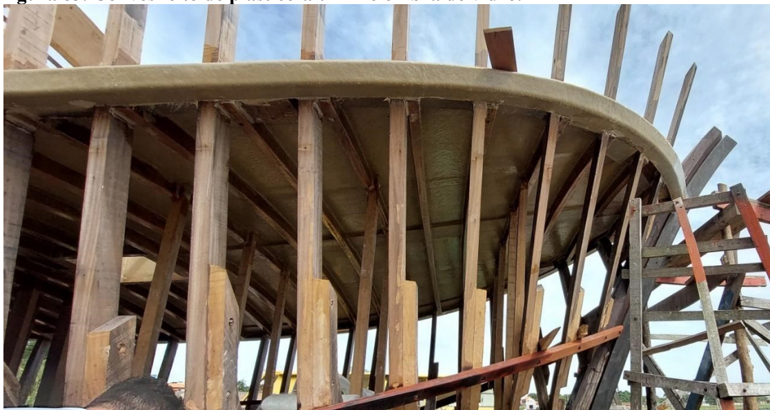
Figura 83. Convés feito de plástico-alumínio e fibra de vidro.
