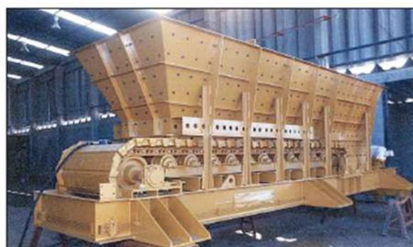
Figura 7: Alimentador de sapatas
