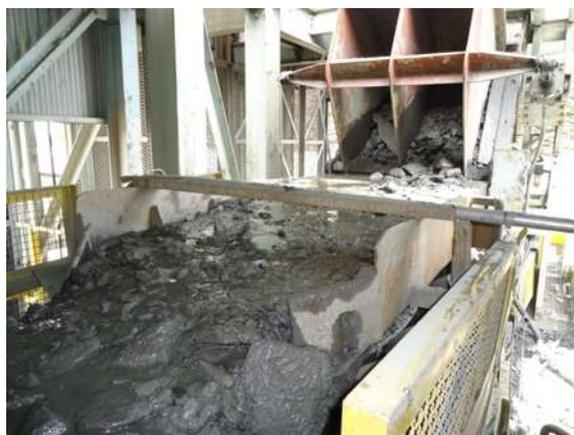
Figura 11: Entupimento por excesso de umidade. Fonte: Foto tirada na unidade de britagem analisada
