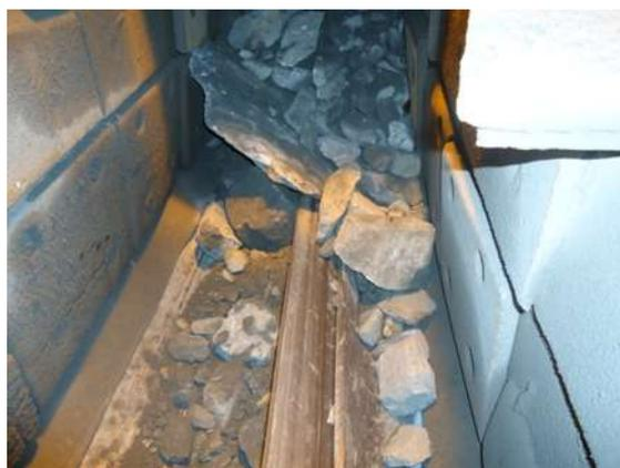
Figura 14: Rasgo de correia por lamela do minério. Fonte: Foto tirada na unidade de britagem analisada
