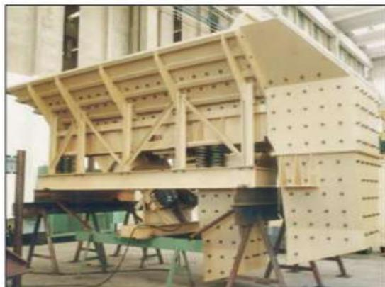
Figura 6: Alimentador vibratório
