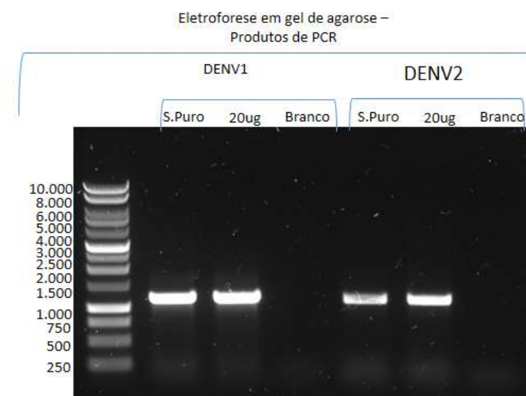
Figura 24 - Eletroforese em gel de agarose dos produtos de PCR gerados a partir do DNA de células HEK293T transduzidas com lentivírus para a expressão da proteína de envelope dos sorotipos 1 e 2 mantidas com e sem pressão seletiva durante 15 passagens. Amplificação de parte da sequência do gene de interesse em amostras de DNA das células HEK293T transduzidas. O DNA genômico foi purificado e amplificado por pares de primers específicos. S.Puro: Produto de PCR do DNA genômico de células HEK293T transduzidas por vetor viral e posteriormente mantidas na ausência de antibiótico de seleção. 20µg: Produto de PCR do DNA genômico de células HEK293T transduzidas por vetor viral e posteriormente mantidas na presença de 20µg/mL de antibiótico de seleção.
