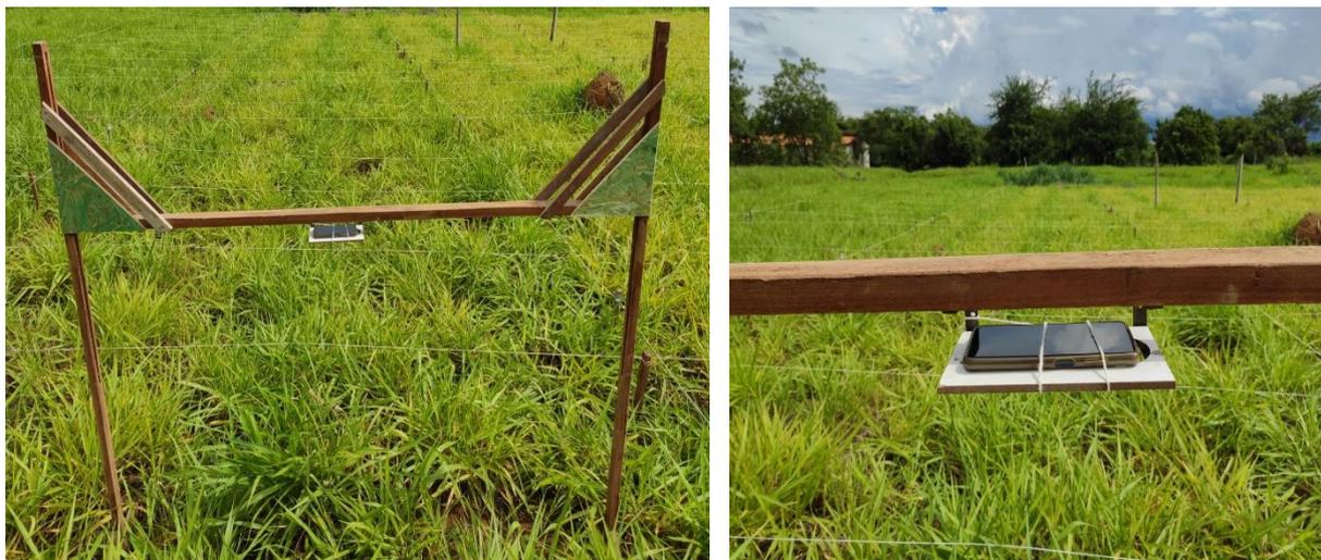
Figura 1. Suporte projetado para captura das imagens em cada parcela após a aplicação do herbicida.
