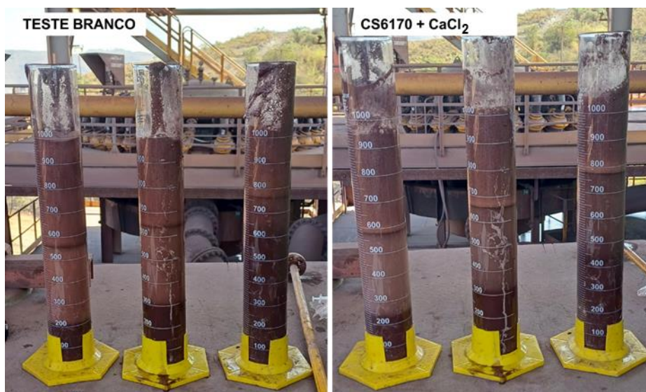
Figura 28: Aspectos da polpa e espuma nos testes branco e com dosagem de CS6170 + CaCl 2 .
