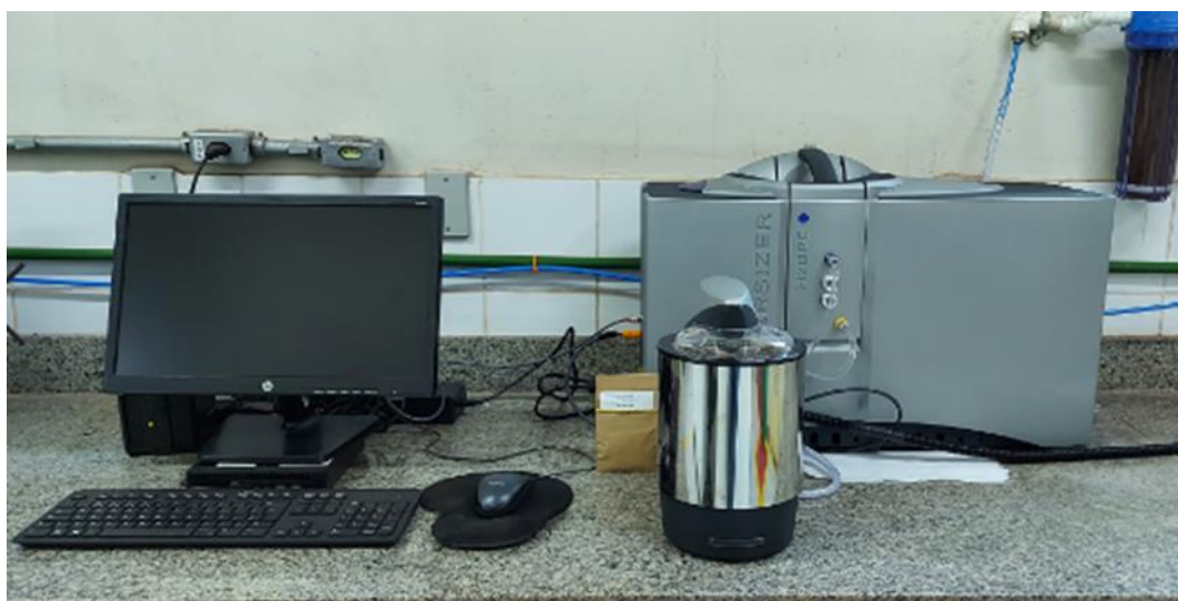
Figura 12: Equipamento Mastersizer 3000 utilizado para o teste granulométrico.
