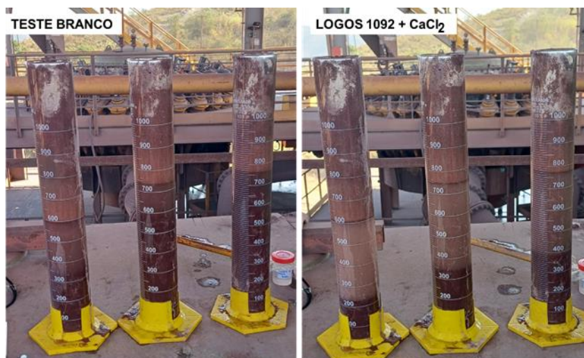
Figura 29: Aspectos da polpa e espuma nos testes branco e teste após dosagem de Logos 1092 + \text{CaCl}_2 .
