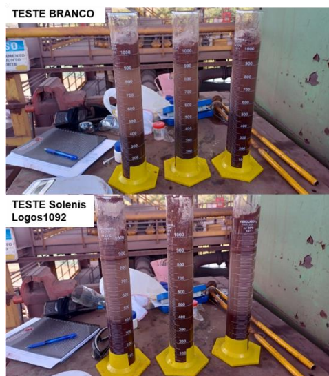
Figura 20: Testes em branco e com antiespumante Solenis Logos 1092.
