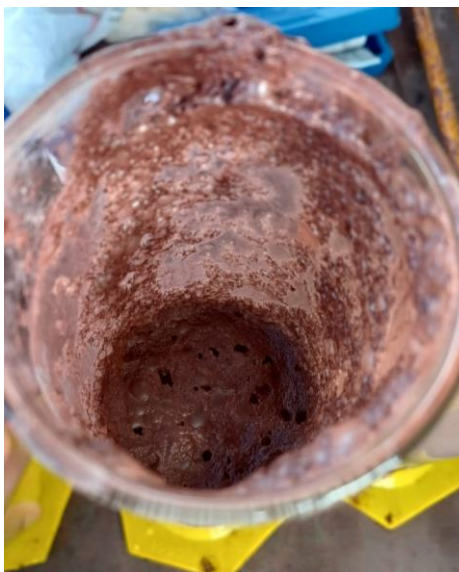
Figura 17: Aspecto da espuma após dosagem do antiespumante CADM – Clariant.
