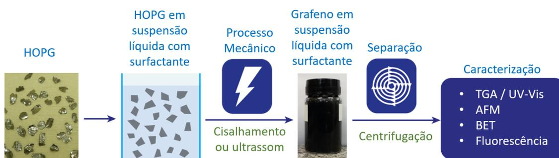
Figura 10 – Visão geral da produção e caracterização das amostras de grafeno produzidas por esfoliação em fase líquida (LPE, do inglês, *Liquid Phase Exfoliation*) utilizadas neste trabalho. HOPG, ou grafite pirolítico altamente orientado (HOPG, do inglês, *highly oriented pyrolytic graphite*) é uma forma altamente pura e ordenada do grafite.
