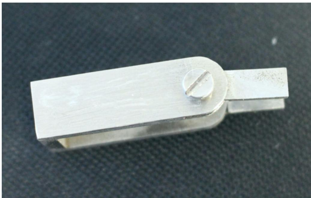
Figura 76 – Ponta pivotante em 90° com o longo eixo do grampo
