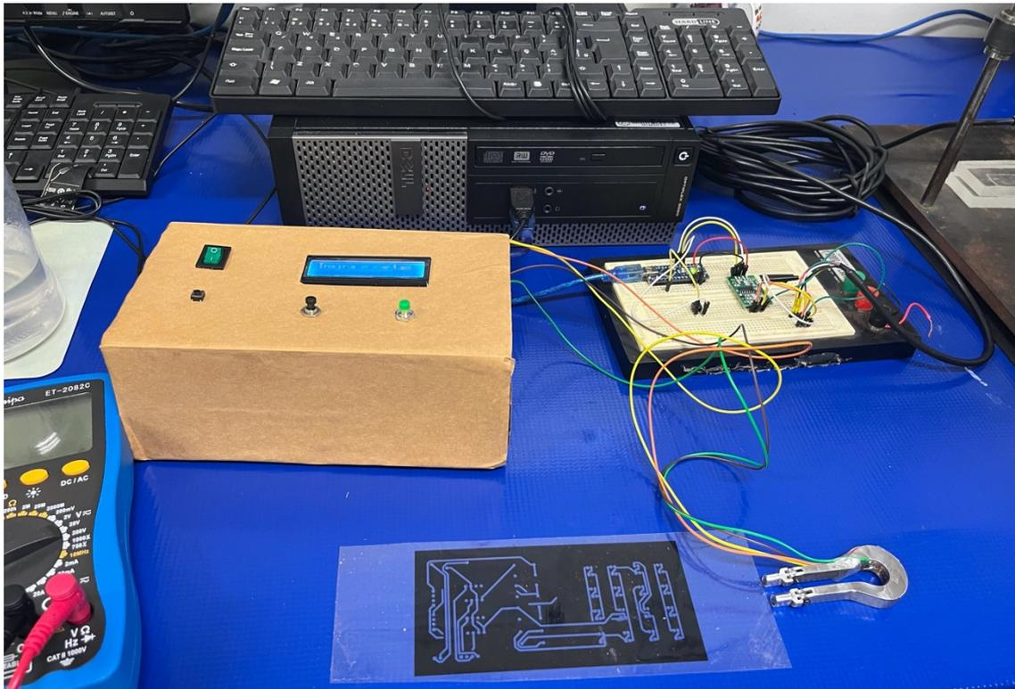
Figura 3. Case do sistema de decodificação com os botões de acionamento
