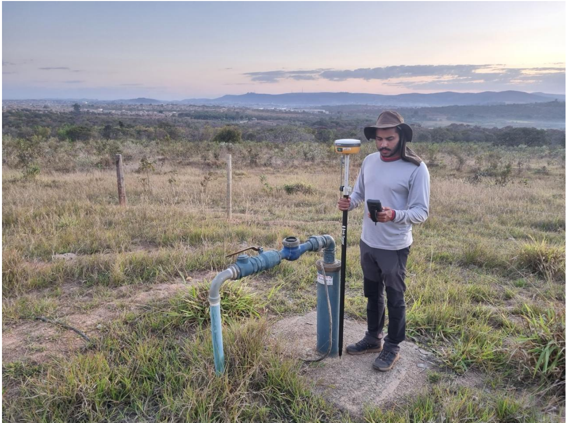
Figura 4.3 - Imagem do levantamento topográfico de um poço tubular próximo de onde foi levantada uma seção de eletrorresistividade.
