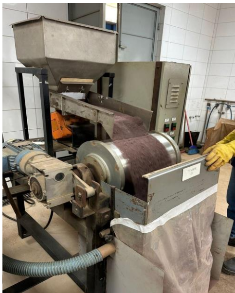
Figura 39 - Tambor magnético 1500 Gauss (Modelo HF)
