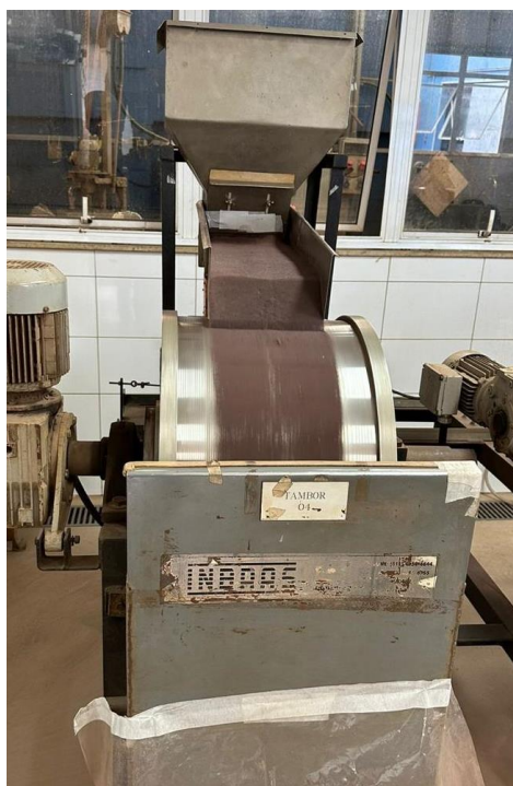
Figura 40 - Tambor magnético 7500 Gauss (Modelo HFRE)
