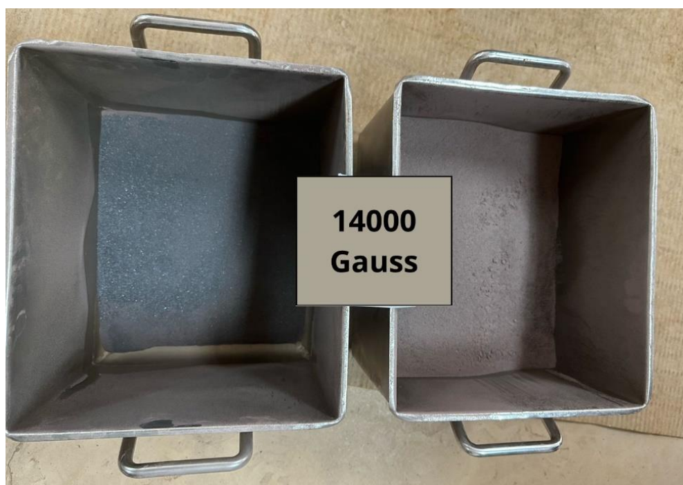
Figura 104 - Concentrado e rejeito da primeira etapa re-roll
