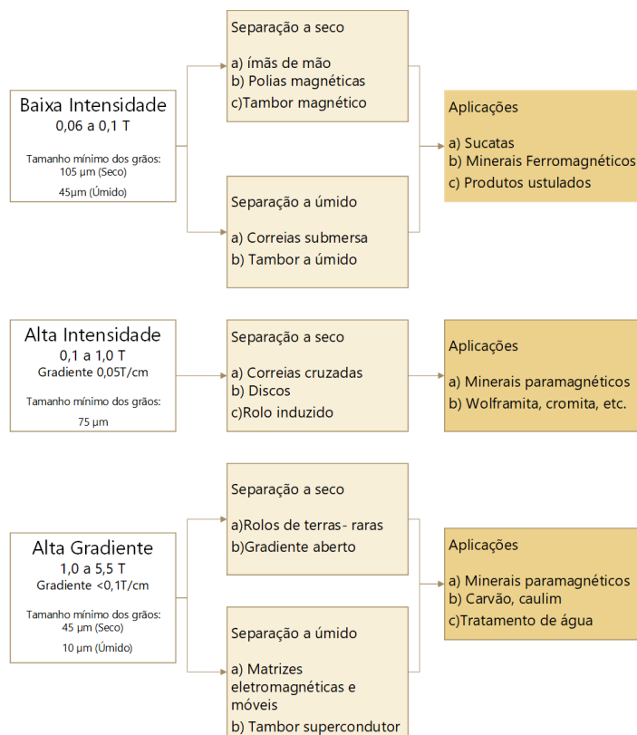
Figura 4-Classificação, características e aplicações de alguns separadores magnéticos.
