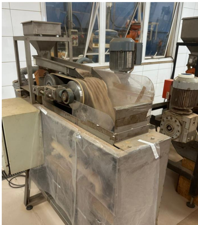
Figura 41- Tambor magnético 14000 Gauss (Modelo RE)
