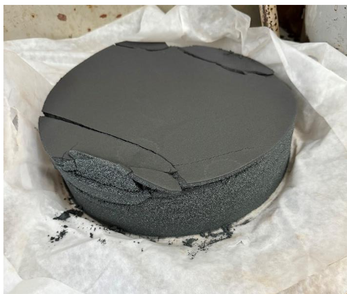
Figura 111 - Concentrado filtrado proveniente do teste 09 (etapa úmida)
