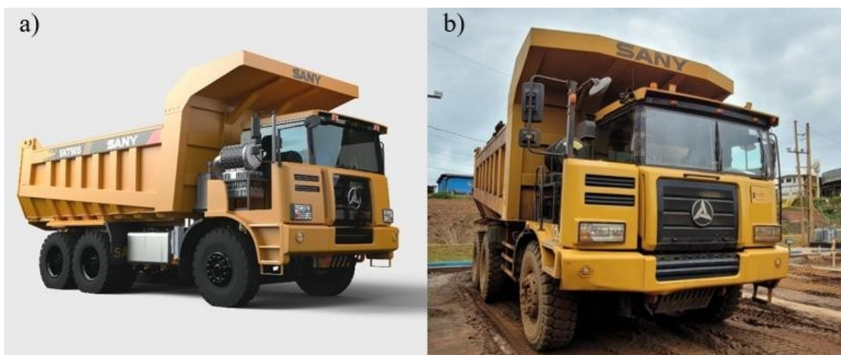
Figura 5 a) Ilustração do caminhão fora de estrada Sany, modelo SKT90S. Fonte: Sany (2024a). b) Caminhão Sany SKT90S da empresa estudada. Fonte: O autor.
