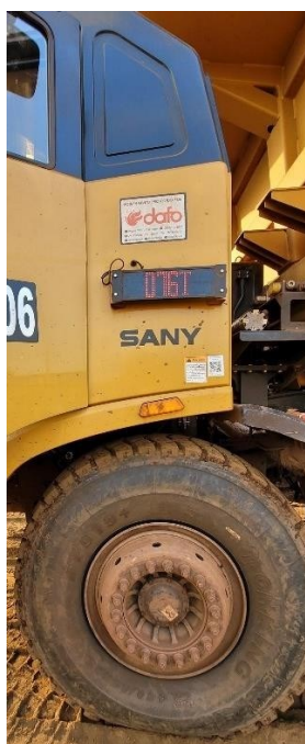
Figura 7 - Balança integrada no caminhão fora de estrada Sany SK110S.
