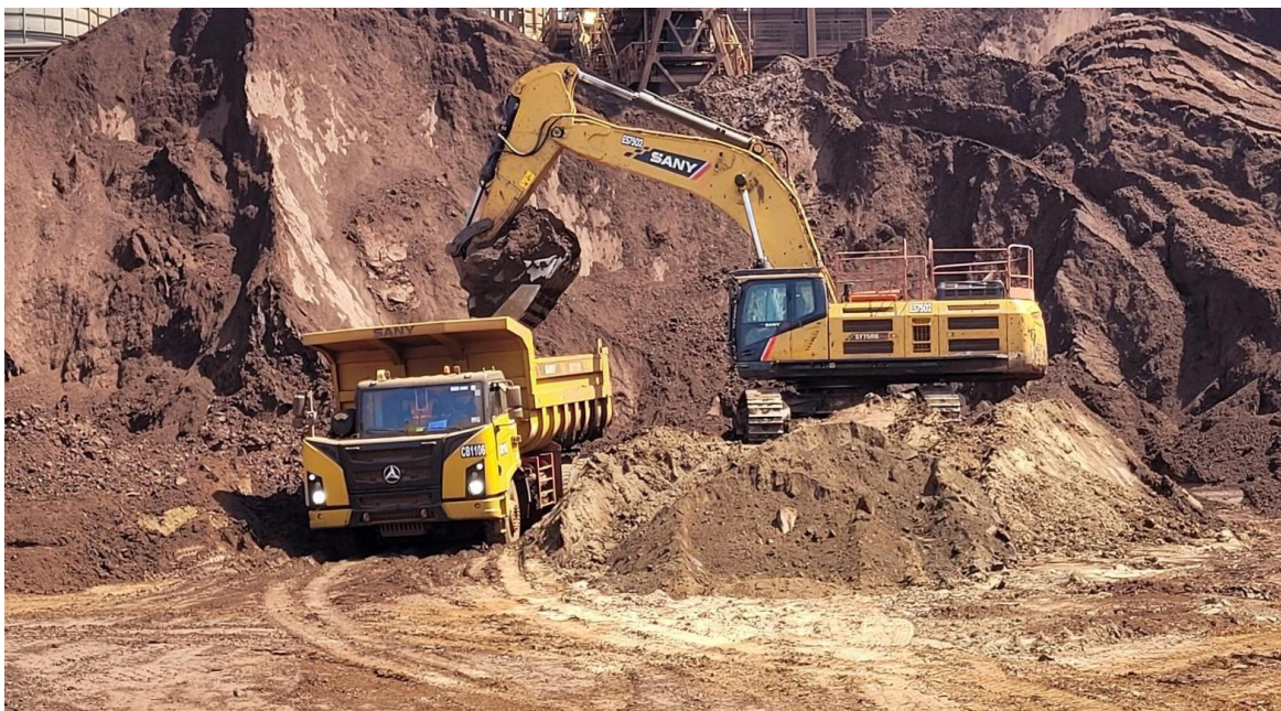
Figura 10 - Carregamento do caminhão Sany SKT110S em teste pela retroescavadeira Sany SY750H no empreendimento em estudo.
