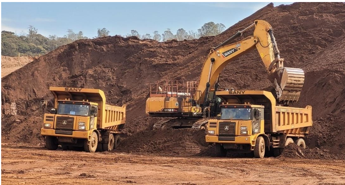
Figura 9 - Carregamento do caminhão Sany SKT90S pela retroescavadeira Sany SY750H no empreendimento em estudo.
