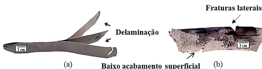
Figura 55. Aspecto das chapas com 1mm de espessura, 150 mm de comprimento e 50 mm de largura após ARB em 3 ciclos com (a) chapas sem adesão e (b) com fraturas laterais e acabamento superficial insatisfatório.
