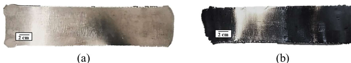
Figura 58. Aspecto de chapas processadas por (a) ARB em 6 ciclos com recozimento inicial e aquecimento intermediário nos ciclos três e cinco, a 400 °C por 5 minutos e (b) CARB, processadas nos mesmos parâmetros.
