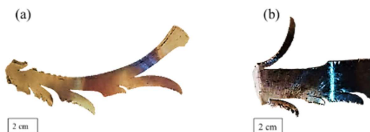
Figura 35. Imagem ilustrativa de fraturas laterais e longitudinais em chapas de alumínio após diversos ciclos de (a) ARB e (b) CARB.
