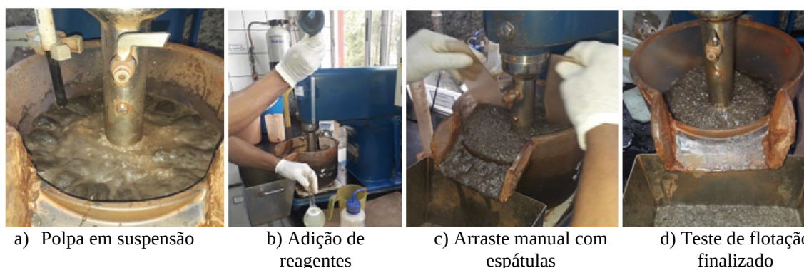
Figura 1. Etapas do processo de flotação em bancada
