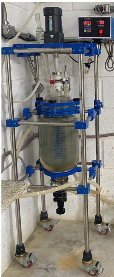
Figura 28 - Reator instalado na empresa Pedras Congonhas – reator com reação em andamento. Massa de partida de serpentinito: 2 kg.
