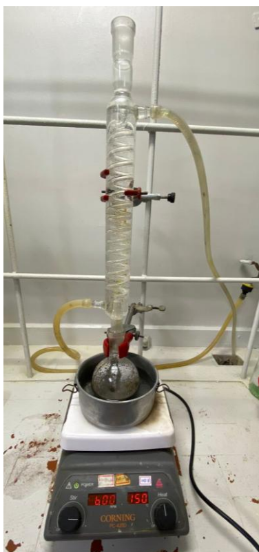
Figura 11 - Sistema de reação para extração ácida aquosa em laboratório em menor escala.
