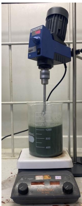
Figura 15 - Sistema montado para síntese de aumento de escala em laboratório.
