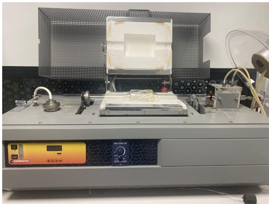
Figura 5 - Forno rotativo com reator de vidro utilizados nos experimentos da rota térmica.
