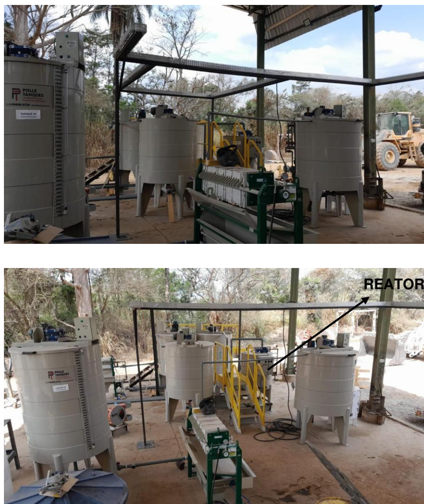
Figura 55 – Montagem da unidade piloto para produção de \text{Mg}(\text{OH})_2 . Volume do reator: 500 L.
