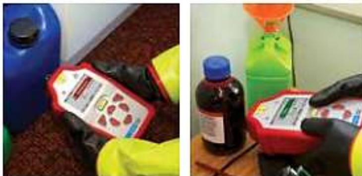
**Figura 43.** Análise Raman utilizando o Equipamento A, sobre recipientes de diferentes materiais (AGILENT®, 2024).
