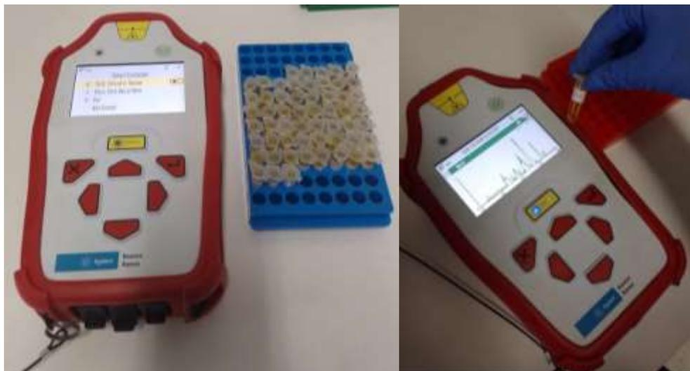
**Figura 20.** Análise das amostras no Agilent Resolve Raman® (Equipamento A).
