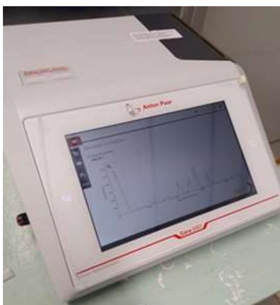
**Figura 21.** Análise das amostras no Cora 5001 da Anton Paar® (Equipamento B).
