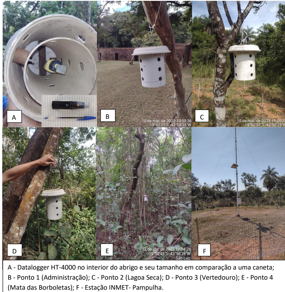
Figura 14 - Datalogger HT-4000 e pontos de instalação dos abrigos climatológicos
