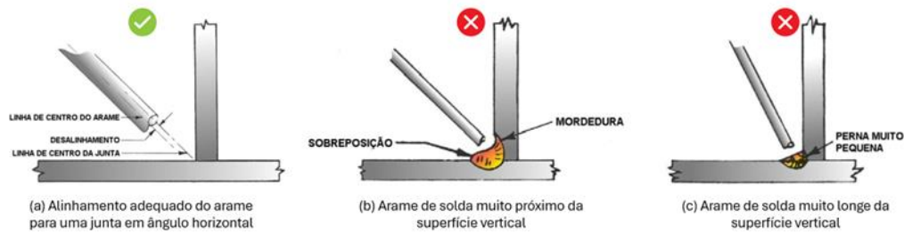
Figura 17 - Influência do alinhamento do arame em relação a junta em ângulo horizontal
