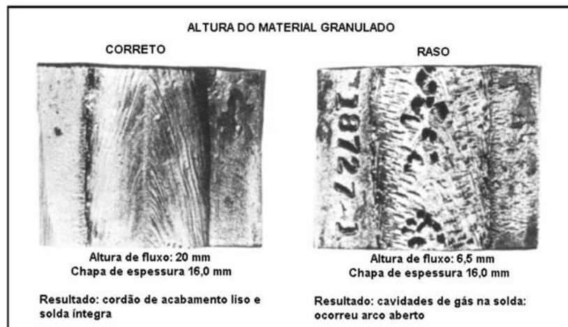
Figura 12 - Influência da camada de fluxo de soldagem na aparência do cordão de solda
