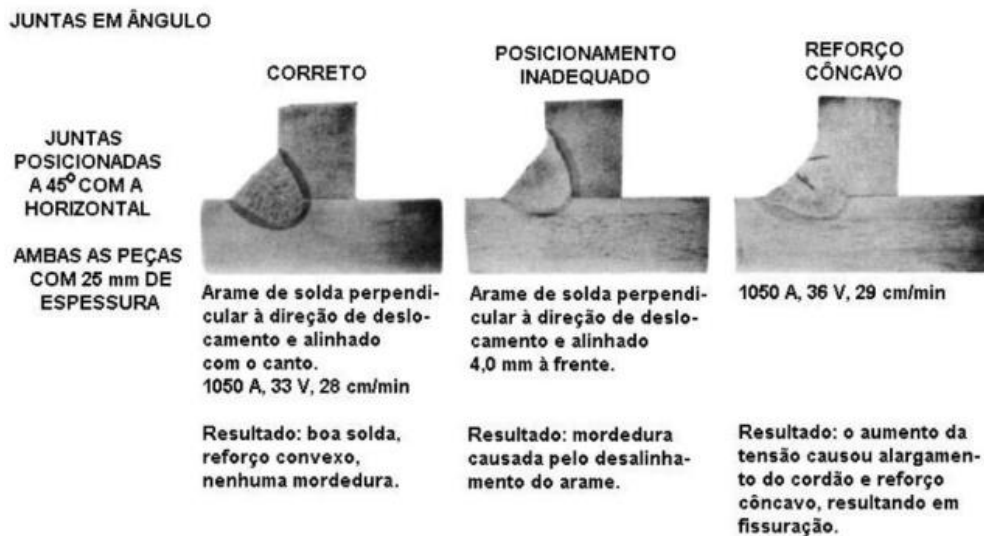
Figura 15 - Efeito do posicionamento do arame na forma do reforço de solda em juntas de ângulo
