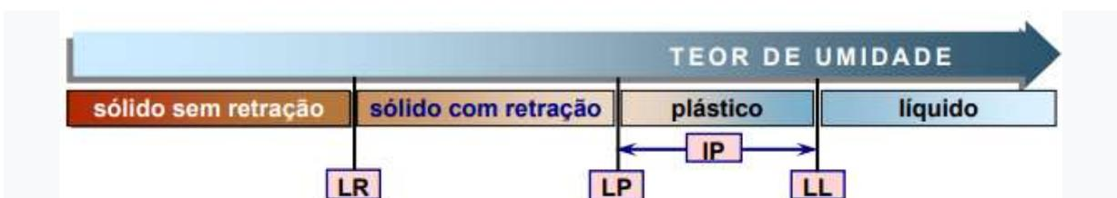
**Fig. 14** – Estado do solo, em função de seu teor de umidade.
