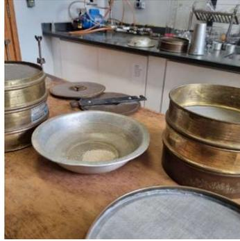
**Fig. 26** – Análise granulométrica por peneiramento grosso.
