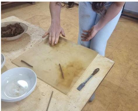
**Fig. 29** – Determinação do LP.
