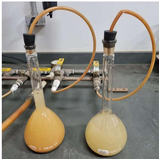
**Fig. 31** – Bomba capaz de aplicar vácuo para a massa específica dos sólidos.
