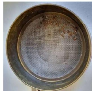
**Fig. 25** – Material retido lavado no peneiramento grosso.
