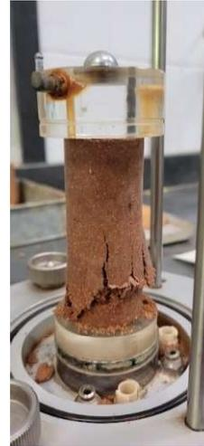
**Fig. 45** – Rompimento do corpo de prova.
