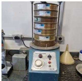
**Fig. 24** – Análise granulométrica por peneiramento fino.
