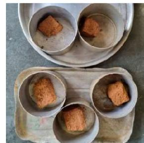
**Fig. 33** – Amostras retiradas dos cinco corpos de prova do ensaio de compactação.
