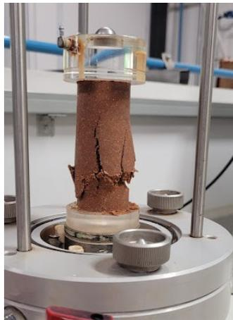
**Fig. 42** – Rompimento do corpo de prova.
