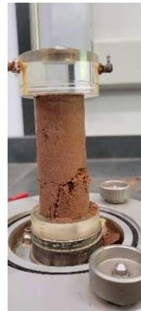
**Fig. 43** – Rompimento do corpo de prova.
