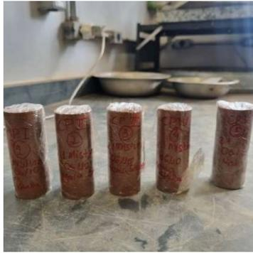
**Fig. 36** – Corpos de prova cilíndricos (T1) para o ensaio de resistência a compressão com ruptura aos 28 dias.
