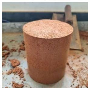
**Fig. 32** – Preparo dos corpos de prova cilíndricos para o ensaio de compactação.
