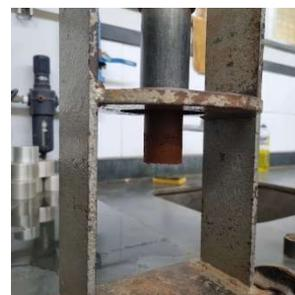
**Fig. 35** – Emprego do extrator para o ensaio de resistência à compressão.
