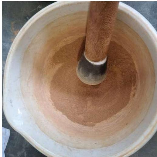
**Fig. 21** – Destorroamento do solo.
