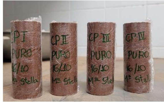
**Fig. 37** – Corpos de prova cilíndricos (T0) para o ensaio de resistência a compressão com ruptura aos 28 dias.
