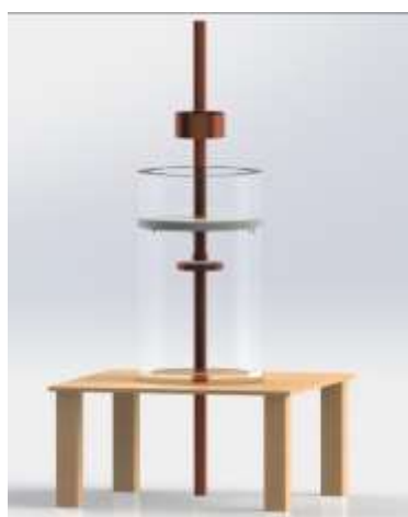
Figura 36 - Esquema do conjunto câmara criogênica e eletrodos inicialmente propostos (3D) - Câmara transparente para melhor visualização.
