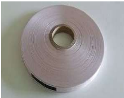
Figura 15 – Amostra de NKN já preparada para enrolamento.
