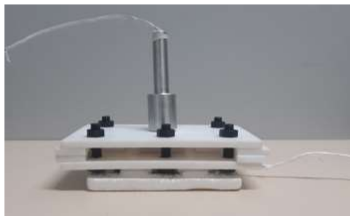
Figura 32 – Porta-amostra para medidas de rigidez com eletrodos iguais (6,4 mm).
