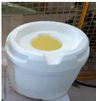
Figura 23 - Câmara criogênica (Cooler de EPS).
