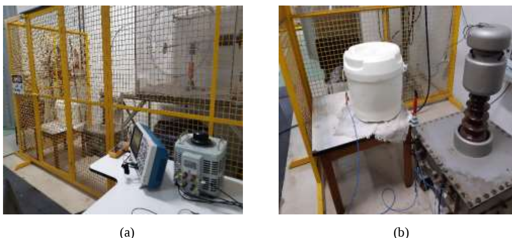
Figura 27 – (a) Variac para produção da rampa de tensão e osciloscópio para medição. (b) Transformador de alta tensão, ponta de prova e câmara criogênica.
