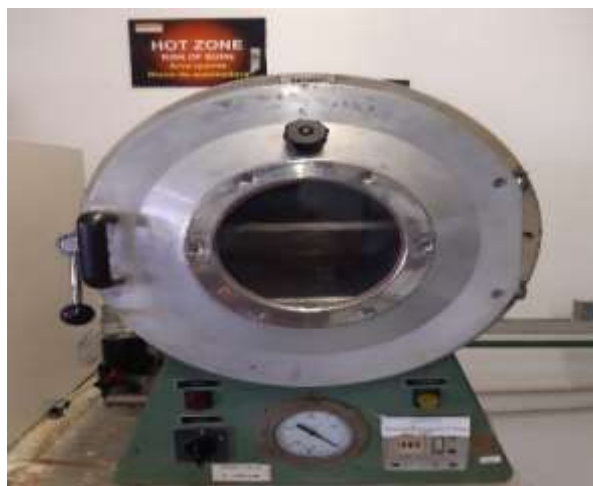
Figura 24 - Estufa de secagem das amostras.
