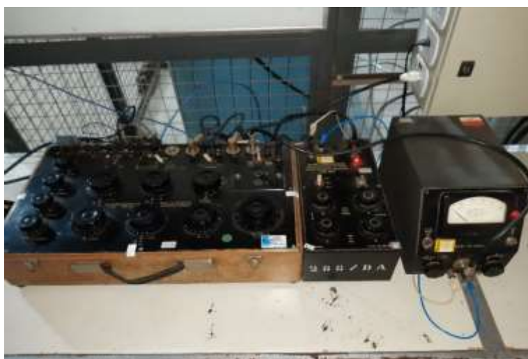
Figura 25 - Ponte Schering – LAT-EFEI.
