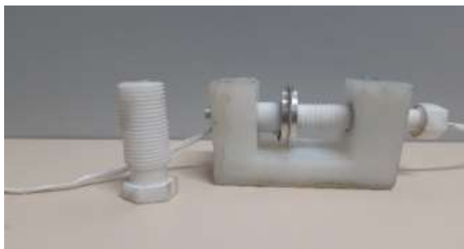
Figura 28 – Porta amostras para medição com LCR.
