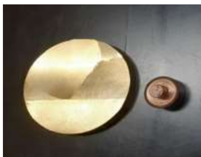
Figura 22 – Eletrodos de 75 e 25 mm usinados.
