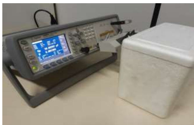
Figura 29 – Medidor LCR e recipiente de EPS com o porta-amostra imerso em N2L.
