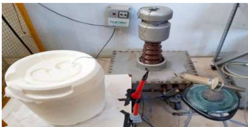
Figura 36 - Fotografia de equipamento para medição de rigidez dielétrica mostrando a câmara criogênica de EPS fechada (esquerda) com os eletrodos dentro, o transformador alta tensão (centro) e pontas de prova de alta tensão (direita e abaixo).
