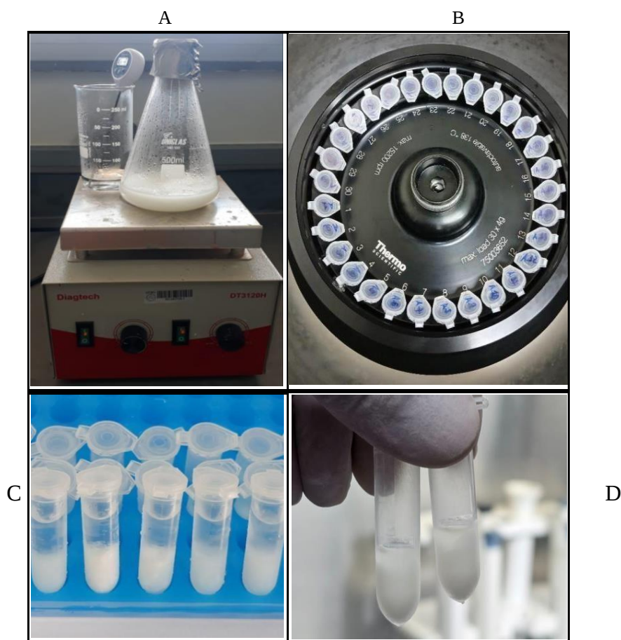
Figura 6. Representação das etapas do protocolo de extração e purificação de kefiran. (A) aquecimento de grãos de kefir; (B) centrifugação; (C) amostras para overnight; e (D) Final do protocolo.
