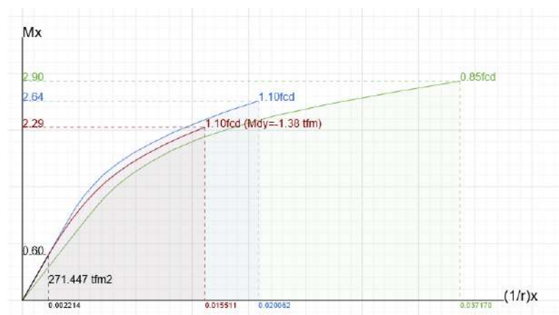
Figura 3.4: Exemplo de Diagrama M - N - 1/r para pilares apresentado pelo TQS®.
