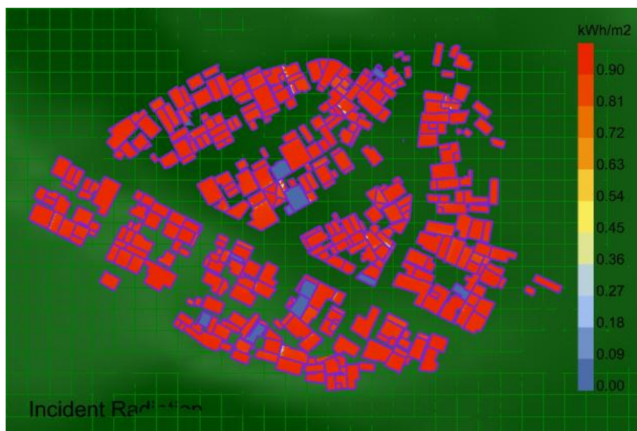
Figura 39: Incidência de radiação utilizando Rhinoceros , a partir dos dados do Grasshopper .
