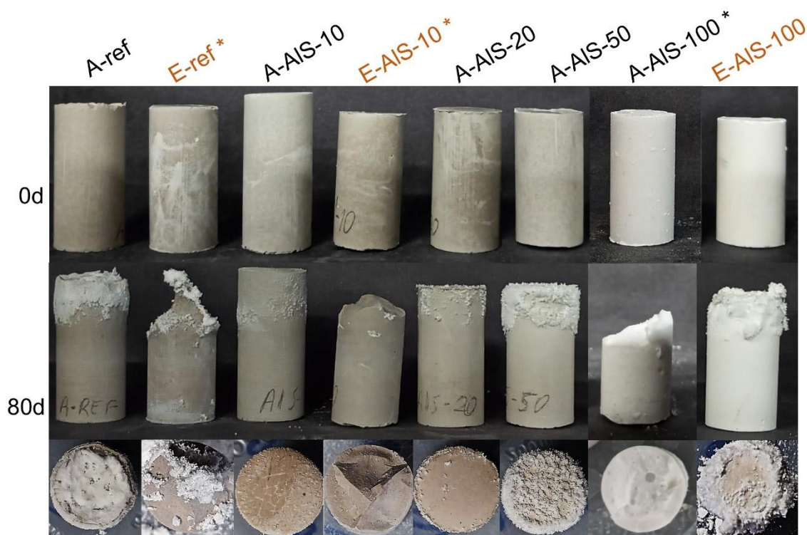
Figura 6.4 – Eflorescência acelerada dos geopolímeros dos tipos A e E à base de metacaulim (MC) puro (A-ref e E-ref), de MC com 10%, 20% e 50% de aluminossilicato sol-gel (AIS) e de AIS puro (A-AIS-100 e E-AIS-100). *Nota: Alguns espécimes sofreram lascamento devido à formação dos cristais de eflorescência.
