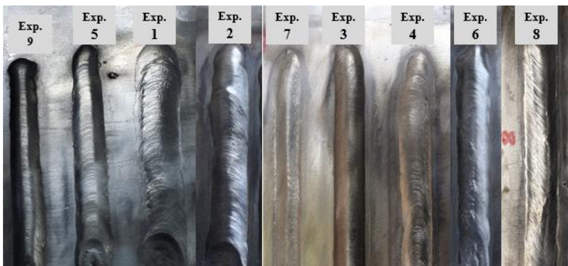
Figura 6 - Resultado de diferentes processos de soldagem em aço AISI 304L
