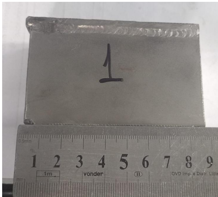
Figura 27 - Corpo de prova utilizado para obtenção de parâmetros de soldagem
