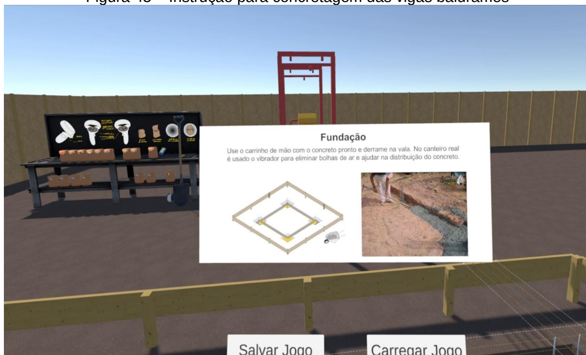
Figura 45 – Instrução para concretagem das vigas baldrame
