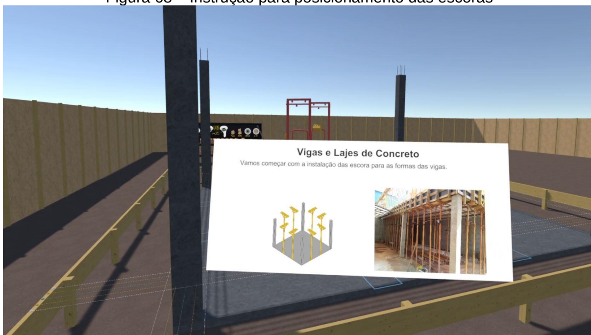
Figura 68 – Instrução para posicionamento das escoras
