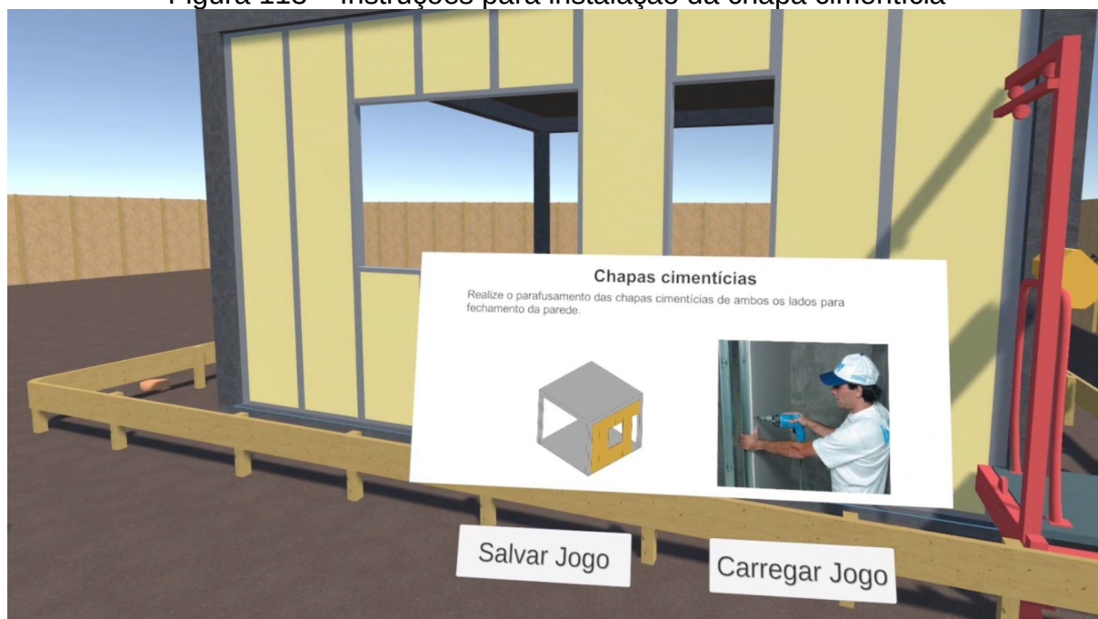
Figura 113 – Instruções para instalação da chapa cimentícia
