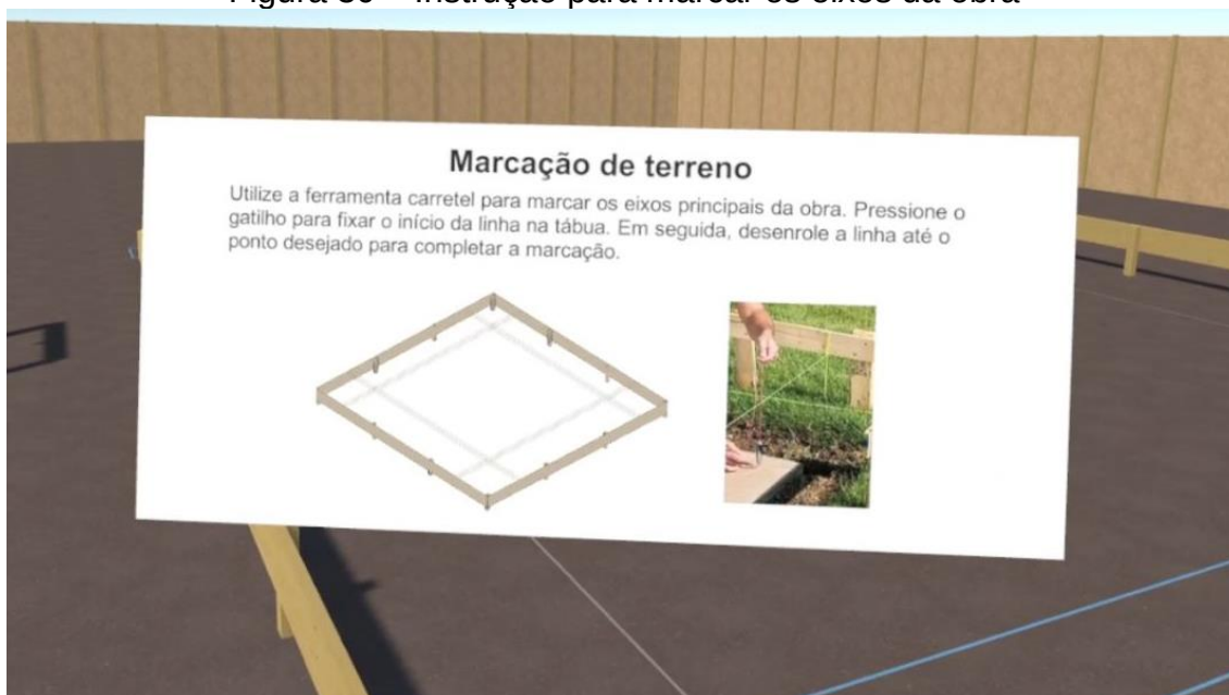
Figura 30 – Instrução para marcar os eixos da obra
