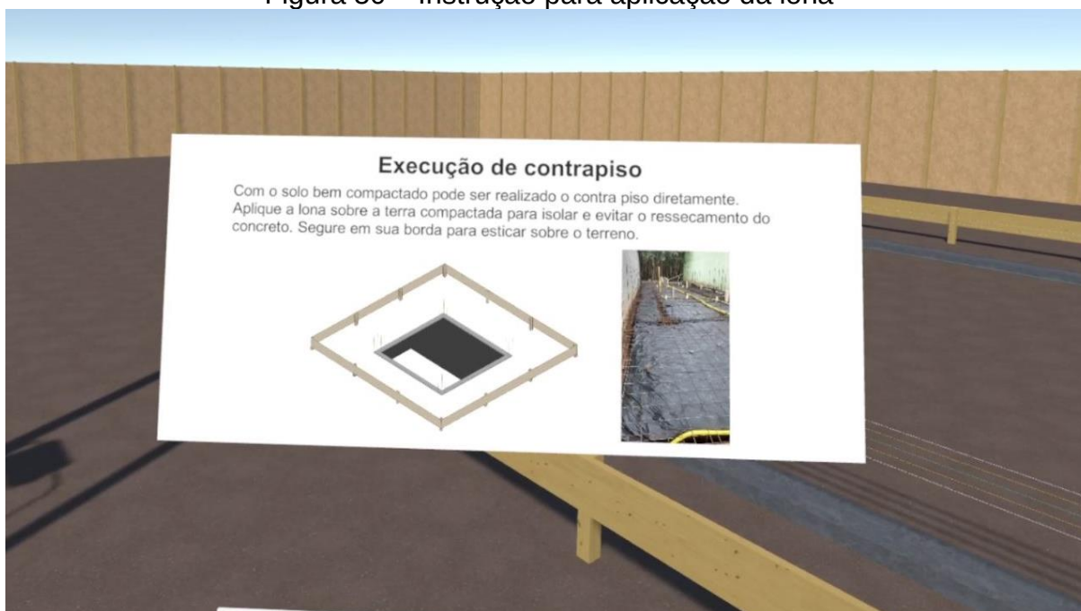
Figura 50 – Instrução para aplicação da lona
