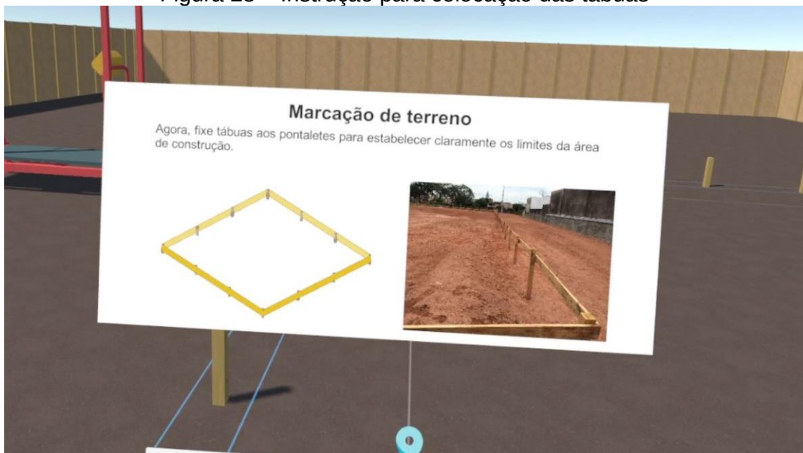
Figura 28 – Instrução para colocação das tábuas
